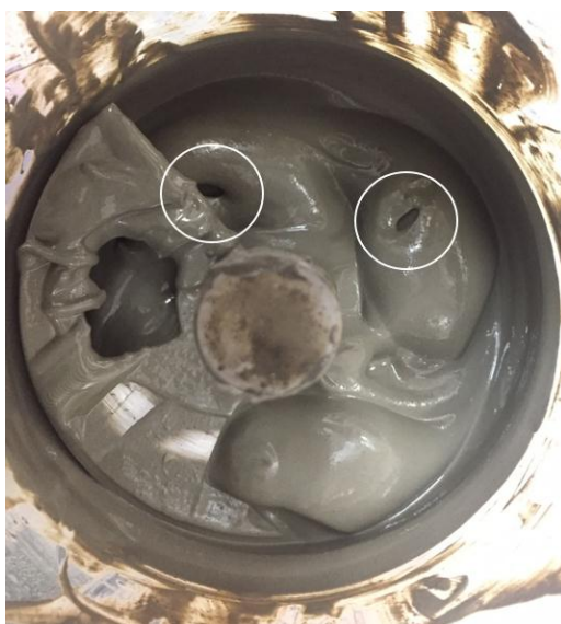
รูปที่ 2.34 ฟองอากาศที่ระเบิดออกมาจากดินเหลว
