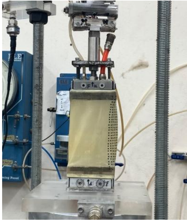
รูปที่ 4.14 ติดตั้งปลายถุงยางด้านบนกับแท่นกด
