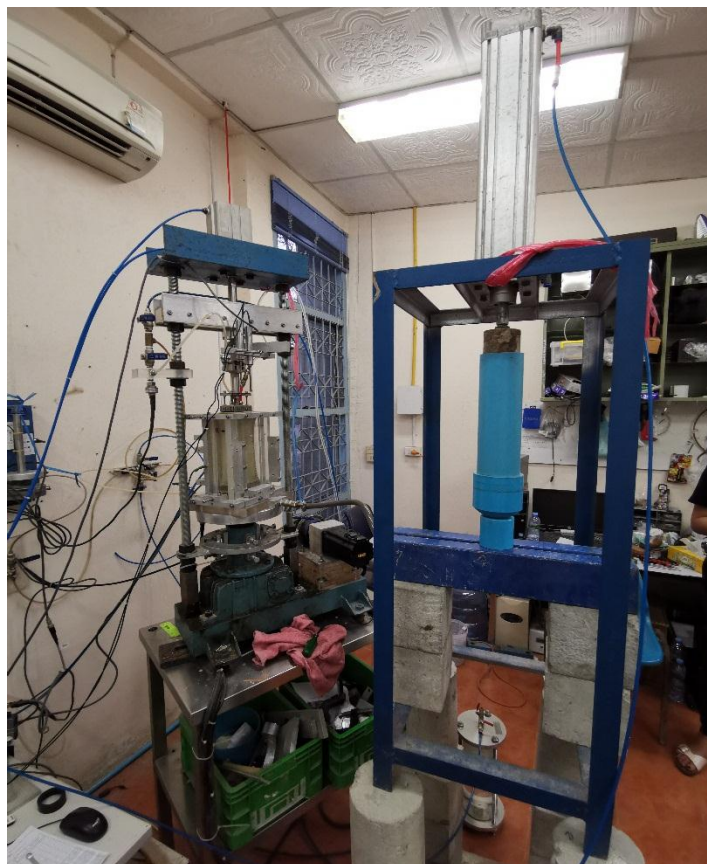
รูปที่ 4.20 การฉีดดินเหลวเข้าเซลล์ทดสอบ
