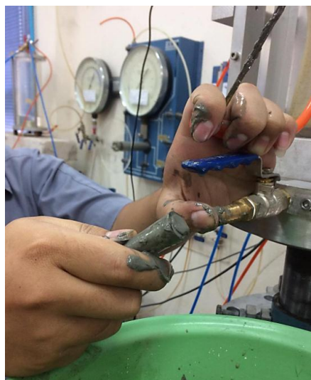
รูปที่ 4.19 การปล่อยน้ำในระบบและการต่อท่อลำเลียงดินเหลวเข้าเครื่องมือทดสอบ
