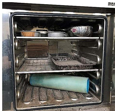
รูปที่ 4.8 การผลิตถุงยาง (ก) การจุ่มยางด้วยแบบท่อ PVC และการพักยางเป็ยก (ข) การอบถุงยาง
