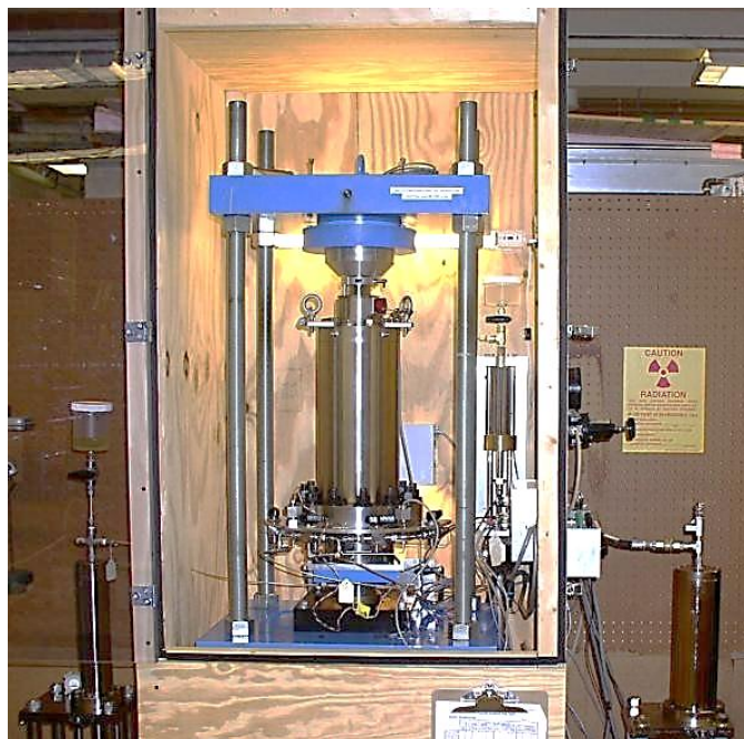
รูปที่ 2.17 เครื่องมือทดสอบแรงอัดสามแกนแบบแรงดันสูง (Casey, 2014)
