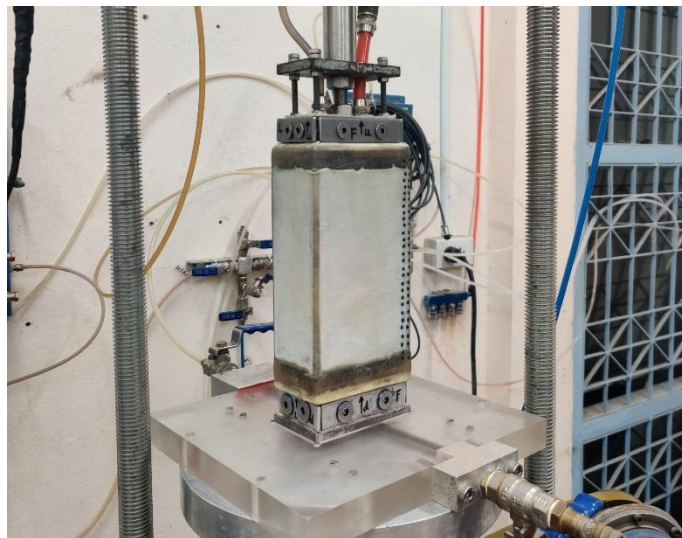
รูปที่ 4.30 ตัวอย่างดินหลังจากถอดแผ่นประกอบออกทั้ง 4 ด้าน
