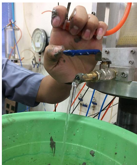
รูปที่ 4.19 การปล่อยน้ำในระบบและการต่อท่อลำเลียงดินเหลวเข้าเครื่องมือทดสอบ
