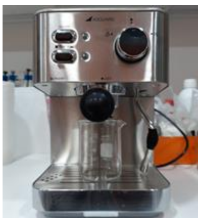
ภาพที่ 11 การสกัดด้วยน้ำร้อนความดันสูง (Pressurized hot water extraction)
