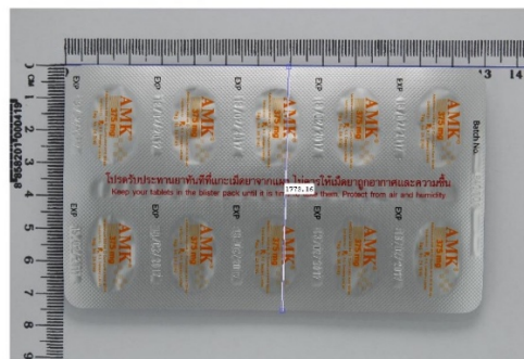
ภาพที่ 2-3 แสดงการวัด Object detection ขนาดของ primary packaging
