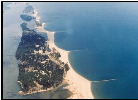
ภาพที่ 2-13 (ซ้าย) รอดักทรายแบบแนวตรงร่วมกับการถมทรายเสริมชายหาดบริเวณอำเภอตากใบจังหวัดนราธิวาส
