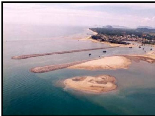
ภาพที่ 2-14 เชือกั้นทรายและคลื่น (บน) บริเวณปากคลองชะอำของบริษัท ชลประทานซีเมนต์ อำเภอลำลูกกา จังหวัดเพชรบุรี (ซ้าย) และ บริเวณปากแม่น้ำปราณบุรี ตำบลปากน้ำปราณ อำเภอปราณบุรี จังหวัดประจวบคีรีขันธ์ (ขวา)
