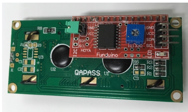
รูปที่ 2.6 โมดูล LCD ต่อกับ I2C Converter Module
