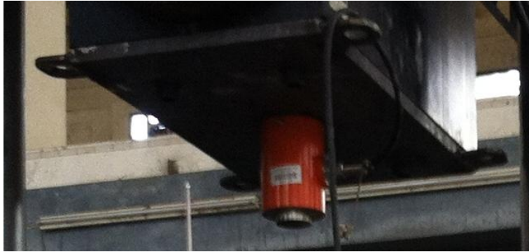
รูปที่ 4.4 แสดงการยึดติดแผ่น Load cell ไปที่ UTM
