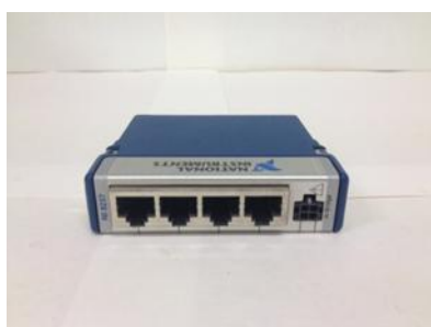
ภาพที่ 3-10 อุปกรณ์แปลงสัญญาณแบบบริดจ์ซึ่งใช้กับหัววัดการเปลี่ยนตำแหน่งหรืออุปกรณ์ตรวจวัดความเร็ว (Bridge transformer module)
