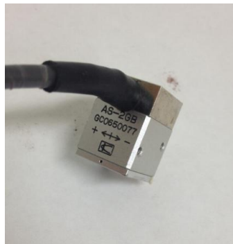
ภาพที่ 3-7 อุปกรณ์ตรวจวัดความเร่ง (Acceleration transducer)
