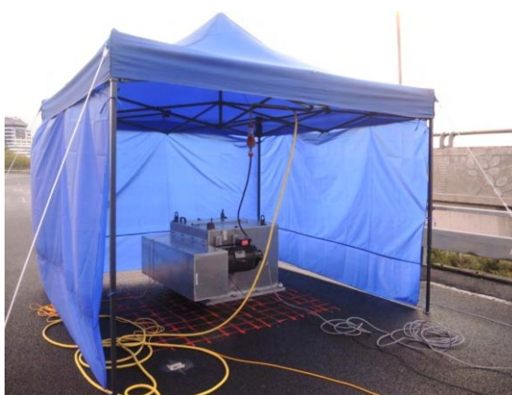
ภาพที่ 2-1 เครื่องให้การสั่นสะเทือนในแนวดิ่ง (Horizontal shaker) ที่ถูกติดตั้งบนสะพาน (Omenzetter et al, 2013)
