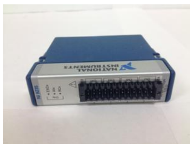
ภาพที่ 3-9 อุปกรณ์แปลงสัญญาณความเครียด (Strain gauge transformer module)
