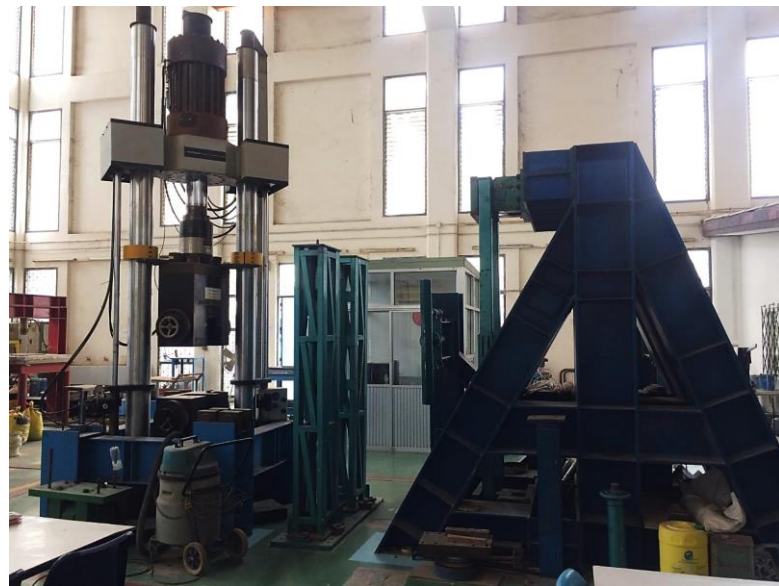
รูปที่ 3.8 เครื่อง Universal Testing Machine (UTM)
