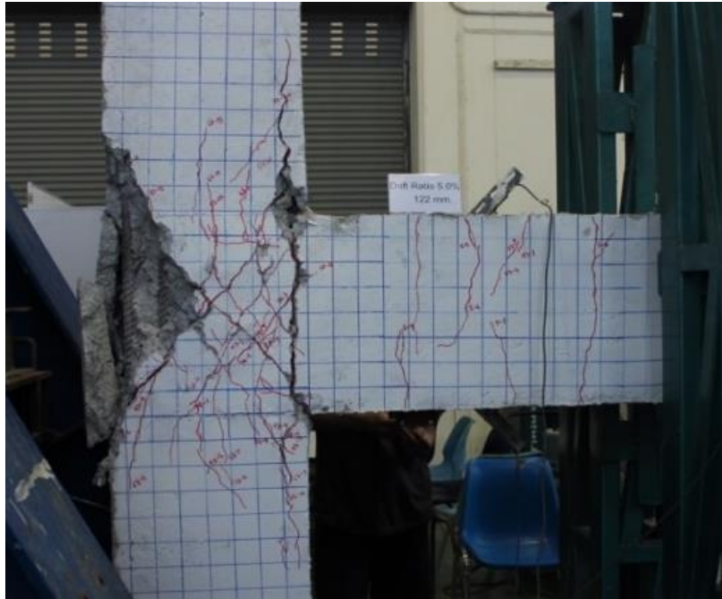
รูปที่ 4.7 แสดงความเสียหายของตัวอย่างที่ drift ratio เท่ากับ 5.0%
