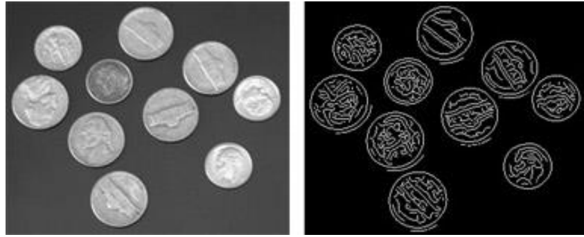
ภาพที่ 1- 9 แสดงขอบภาพ image segmentation โดยใช้วิธีของ Canny method
