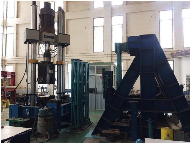
รูปที่ 3.4 เครื่อง Universal Testing Machine (UTM)
