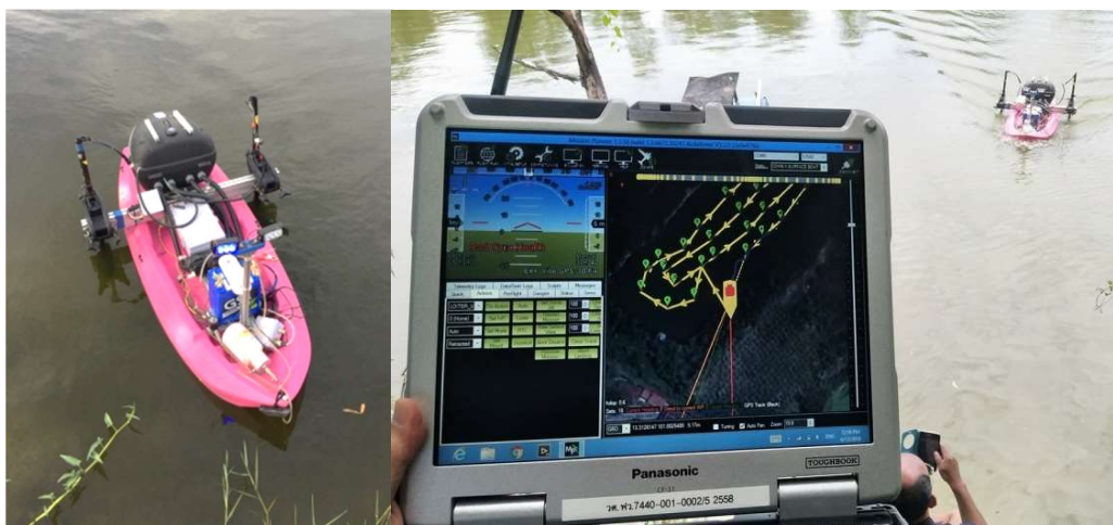
ภาพที่ 3-1 เรืออัตโนมัติสำหรับงานสำรวจและเก็บข้อมูลทางด้านสิ่งแวดล้อม
