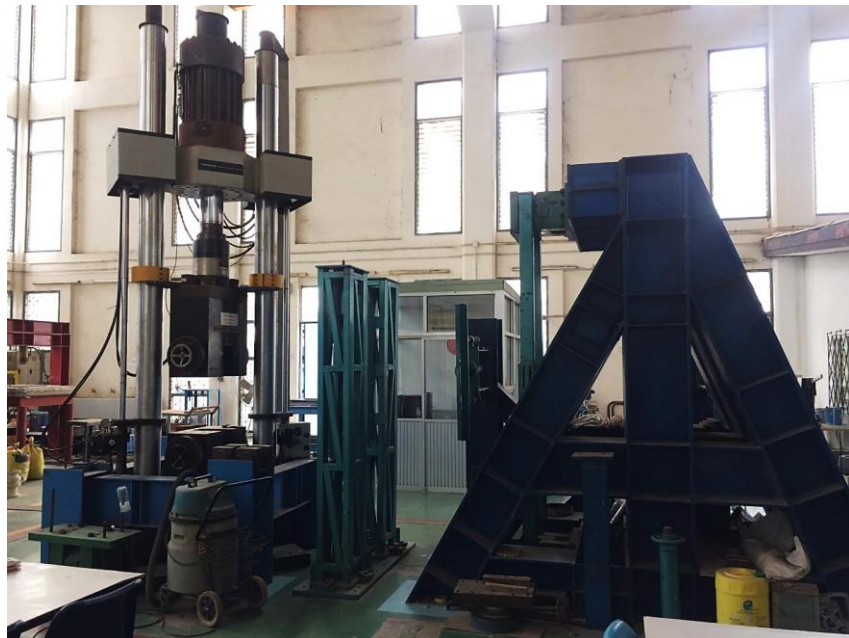
รูปที่ 3.12 เครื่อง Universal Testing Machine (UTM)
