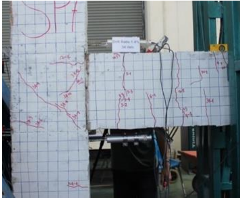
รูปที่ 4.16 แสดงความเสียหายของตัวอย่างที่ drift ratio เท่ากับ 1.4%
