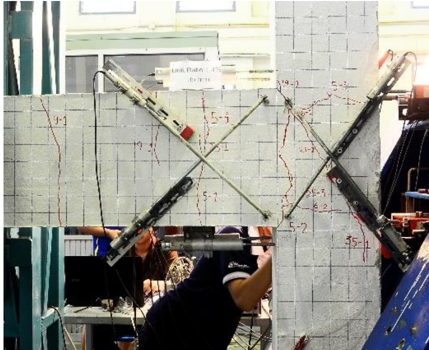
รูปที่ 4.9 แสดงความเสียหายของตัวอย่างที่ Drift Ratio เท่ากับ 1.4%
