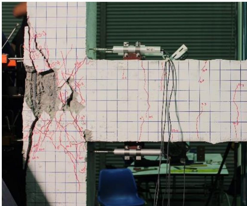
รูปที่ 4.3 แสดงความเสียหายของตัวอย่างที่ drift ratio เท่ากับ 3.5%
