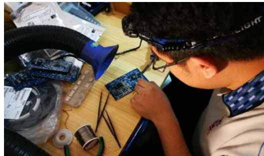
(ก) แผงวงจรพิมพ์แบบ Double Layer และการลงอุปกรณ์ชนิด SMD ของชุดควบคุม
