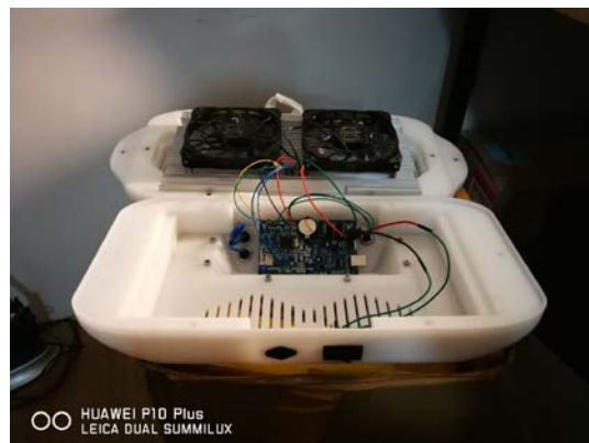
(จ) การประกอบพัดลมระบายความร้อน เข้ากับ Aluminum Heatsink และเชื่อมต่อไปยังแผงวงจร
