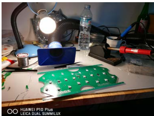
(ค) การติดตั้งหลอดแอลอีดี และเซนเซอร์วัดอุณหภูมิลงบนแผ่นวงจร PCB
