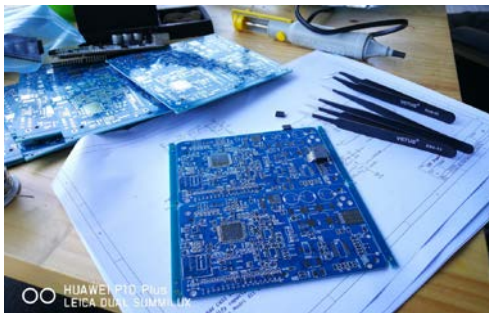
(ก) แผงวงจรพิมพ์แบบ Double Layer และการลงอุปกรณ์ชนิด SMD ของชุดควบคุม
