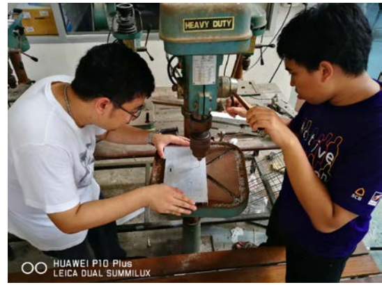
(ง) การเจาะรูและสร้างเกลียวบน Aluminum Heatsink สำหรับยึดพัดลมระบายความร้อน
