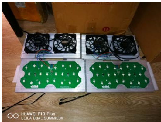
(จ) การประกอบพัดลมระบายความร้อน เข้ากับ Aluminum Heatsink และเชื่อมต่อไปยังแผงวงจร
