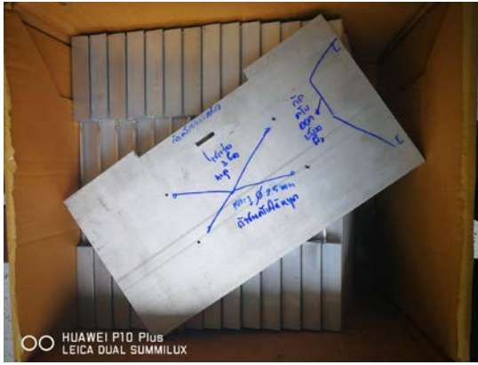
(ง) การเจาะรูและสร้างเกลียวบน Aluminum Heatsink สำหรับยึดพัดลมระบายความร้อน
