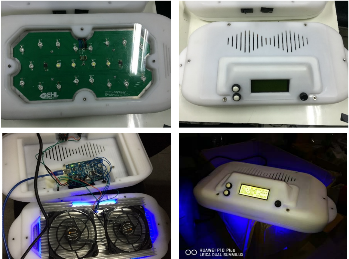
ภาพที่ 3.10 โคมไฟต้นแบบที่ประกอบเสร็จพร้อมนำไปใช้งาน
