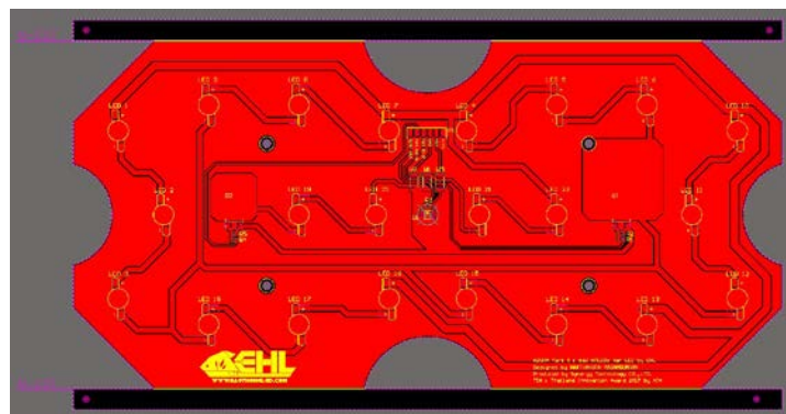
(ข) ลายวงจรแบบ Single Layer ของ Aluminum PCB
