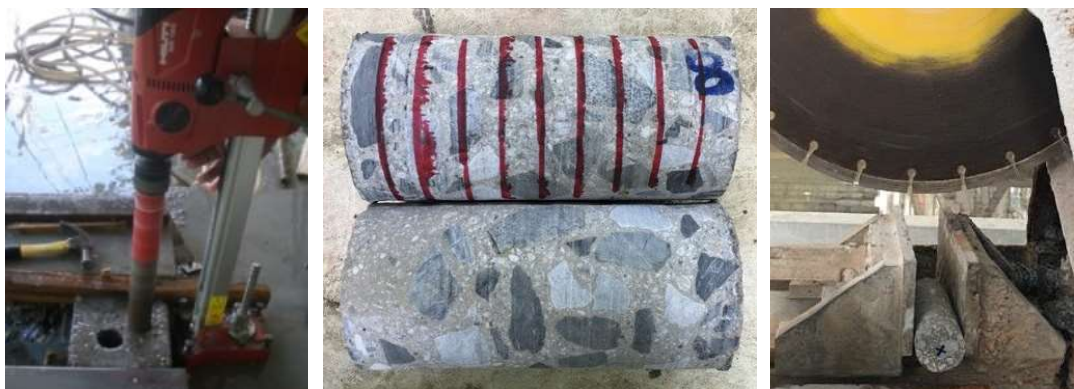
ภาพที่ 3-9 การเตรียมตัวอย่างคอนกรีต
