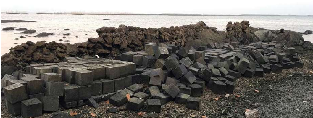
ภาพที่ 3-8 บริเวณวางตัวอย่างคอนกรีตในสิ่งแวดล้อมทะเลที่วัด โคมุทพัฒนาราม
