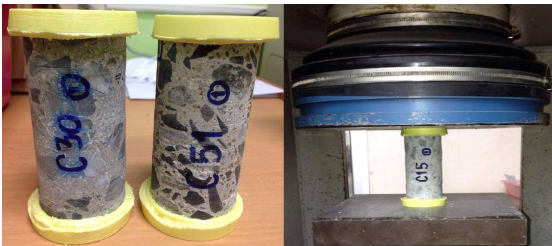
ภาพที่ 3-12 แท่งตัวอย่างสำหรับทดสอบกำลังอัด และการทดสอบกำลังอัด
