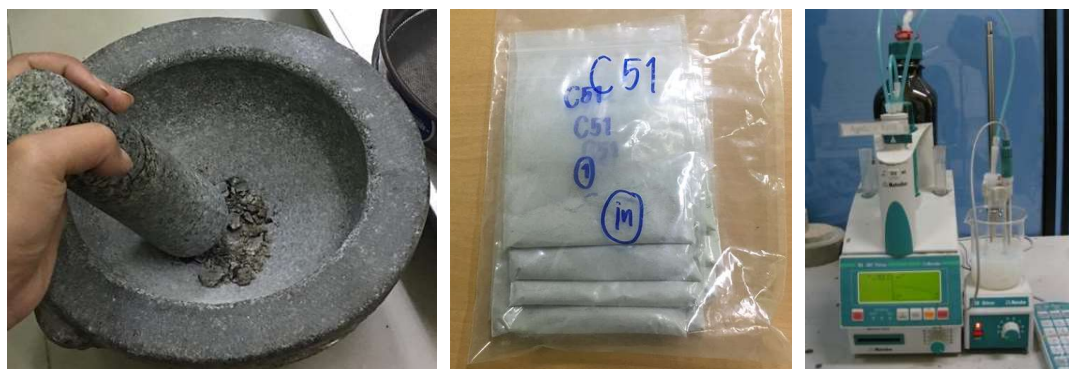
ภาพที่ 3-10 การบดตัวอย่าง ผงตัวอย่างที่ทำการเก็บ และเครื่องไตเตรทอัตโนมัติ
