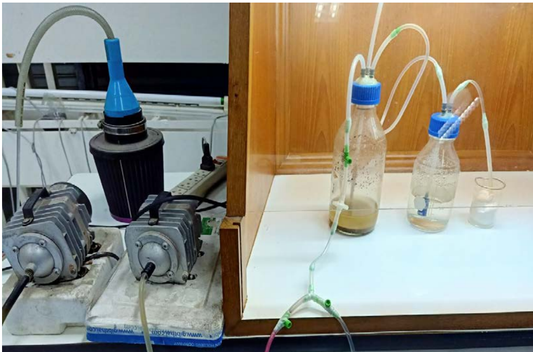
รูปที่ 17 แสดงแผนผังและการต่ออุปกรณ์สำหรับถังปฏิกรณ์แบบกะ
