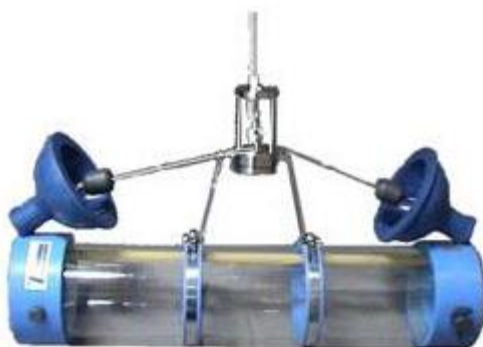
ภาพที่ 2 - 2 กระบอกเก็บน้ำแบบ Van Dorn เพื่อเก็บน้ำวิเคราะห์ธาตุอาหาร และตะกอนแขวนลอยในน้ำ
