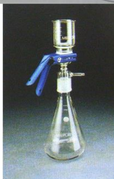
ภาพที่ 2 - 3 อุปกรณ์การกรองน้ำเพื่อการวิเคราะห์สารประกอบไนโตรเจน ฟอสเฟตละลายน้ำ ซิลิเกตละลายน้ำ และตะกอนแขวนลอยในน้ำ
