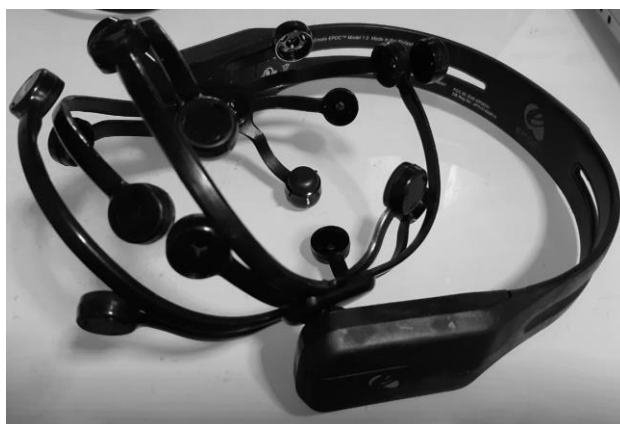
ภาพที่ 2-11 เครื่องวัดคลื่นไฟฟ้าสมองชนิดพกพา Emotiv Epoc
