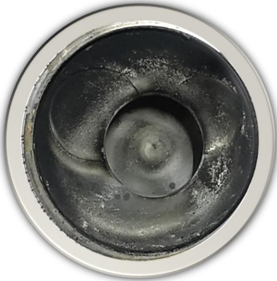
(ก) คราบเขม่าบนหัวลูกสูบ ที่ใช้น้ำมัน D
