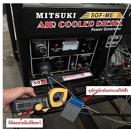
ภาพที่ 2.21 ดิจิตอลแคลมป์มิเตอร์ที่ใช้ในการสอบเทียบ
