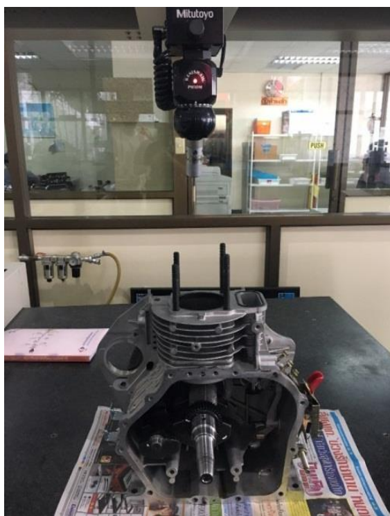
ภาพที่ 2.31 การวัดเส้นผ่านศูนย์กลางปลอกสูบโดยใช้เครื่อง Coordinate measuring machine
