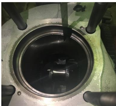
ภาพที่ 2.27 การใช้ฟิลเลอร์เกจสอดเข้าไปเพื่อวัดระยะห่างปากแหวน
