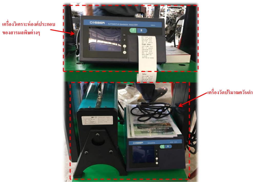
ภาพที่ 2.25 เครื่องวิเคราะห์ห้องค์ประกอบของแก๊สไอเสียที่ใช้ในการวิจัย
