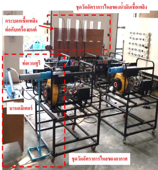
(ก) ชุดวัดอัตราการไหลของน้ำมันเชื้อเพลิง
