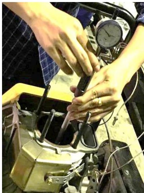
ภาพที่ 2.29 การวัดเส้นผ่านศูนย์กลางปลอกสูบจากเครื่องยนต์ที่ใช้ทดสอบโดยใช้เบอร์เกจ
