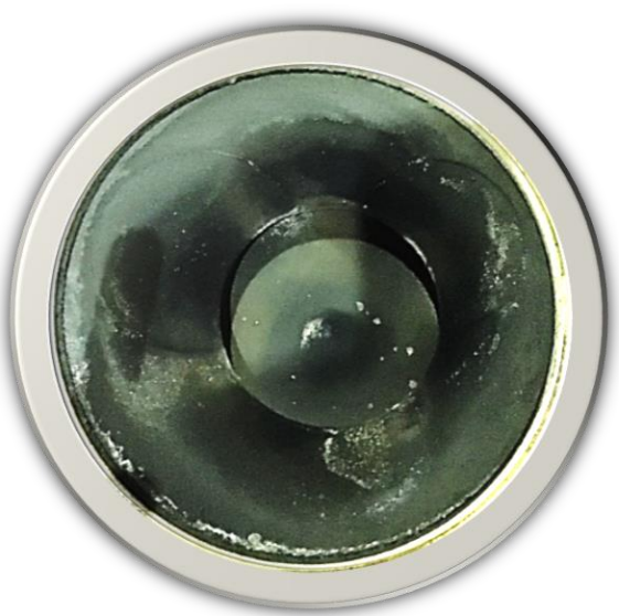
(ง) คราบเขม่าบนหัวลูกสูบ ที่ใช้น้ำมัน DEBi
