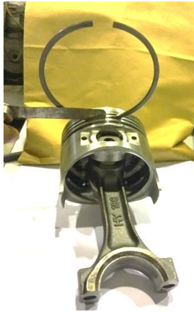
ภาพที่ 2.28 การวัดช่องว่างระหว่างแหวนกับร่องแหวนลูกสูบโดยใช้ฟีลเลอร์เกจ
