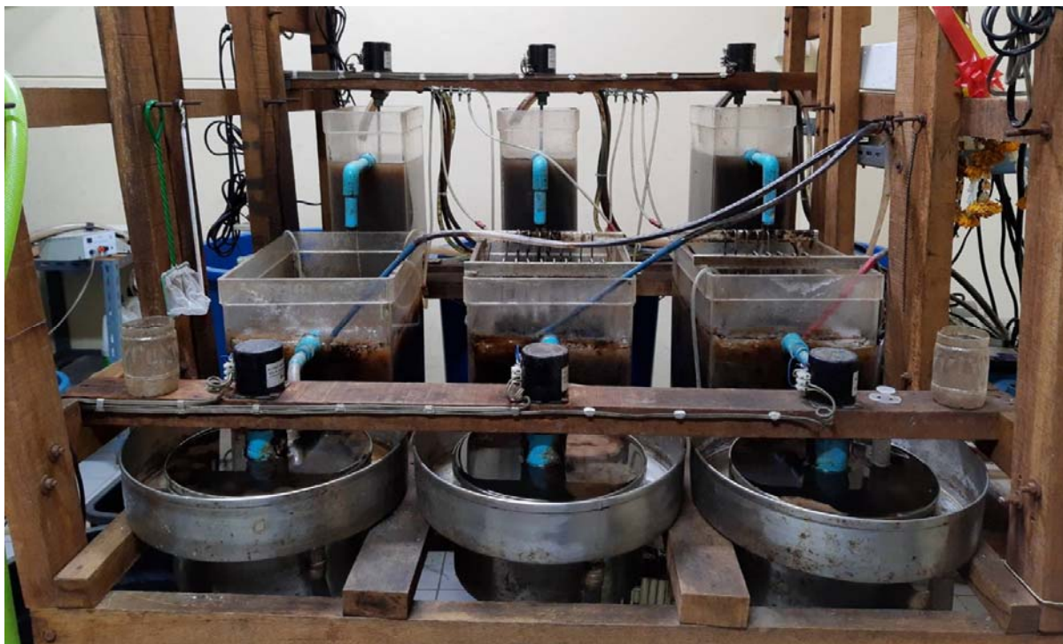
ภาพที่ 2.2 ระบบบำบัดน้ำเสียทางชีวภาพจำลองแบบ Modified Ludzack-Ettinger (MLE)
