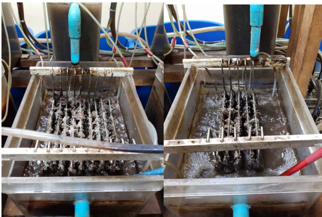
ภาพที่ 2.4 ถังปฏิบัติการภายนอกของระบบ (ก) IFAS-1 และ (ข) IFAS-2
