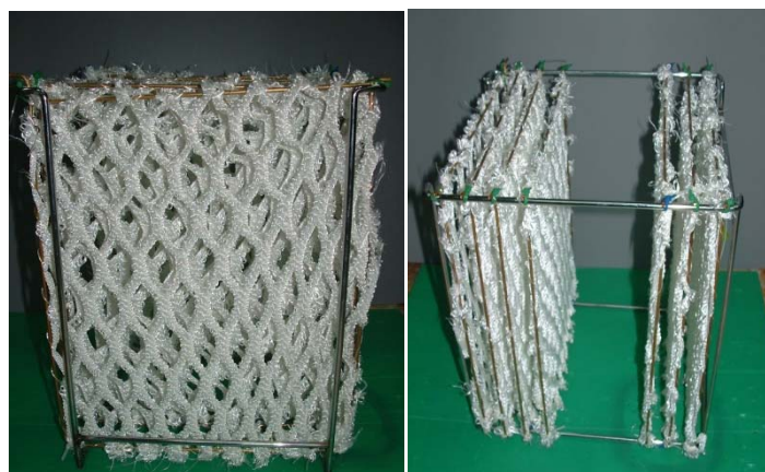
ภาพที่ 2.6 ลักษณะของตัวกลาง Bioweb ที่ติดตั้งในถังปฏิกรณ์เติมอากาศของระบบ IFAS-1 และ IFAS-2
