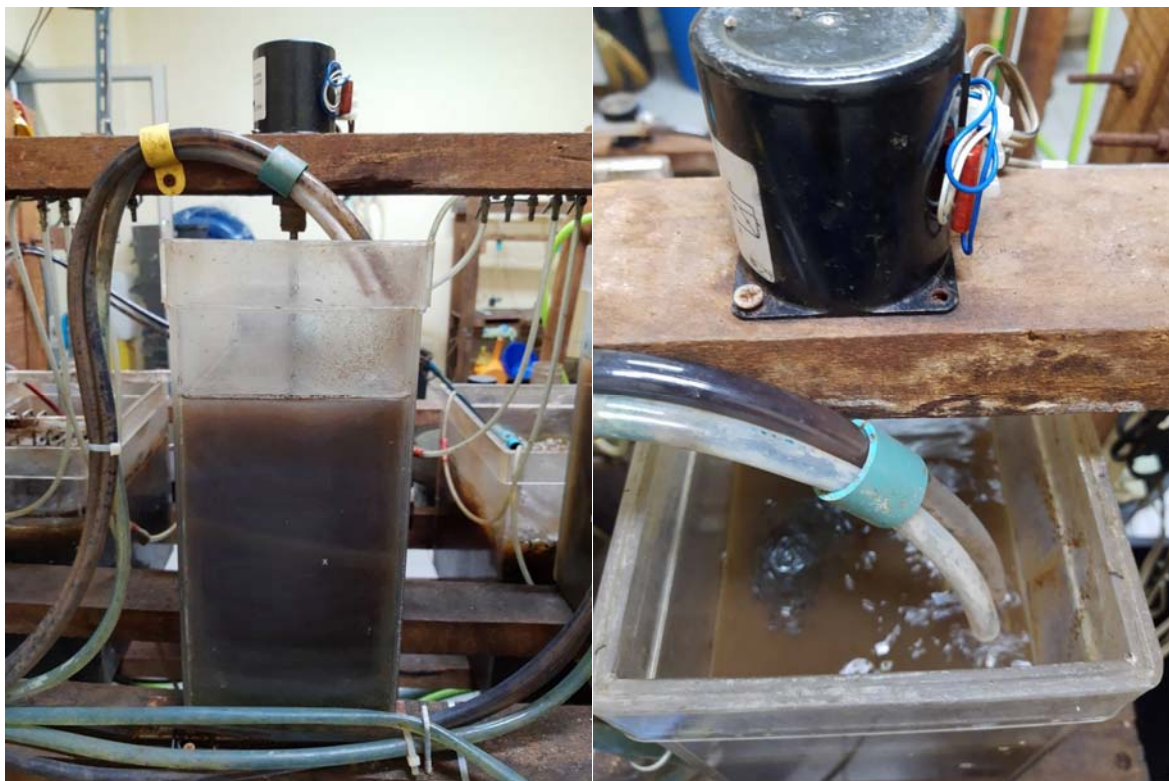
ภาพที่ 2.3 ถังปฏิบัติการภายนอกของระบบ IFAS-1 และ IFAS-2
