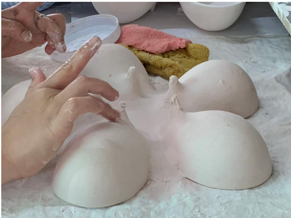
ภาพที่ ๓๔ การขึ้นรูปด้วยการหล่อและต่อประกอบ
