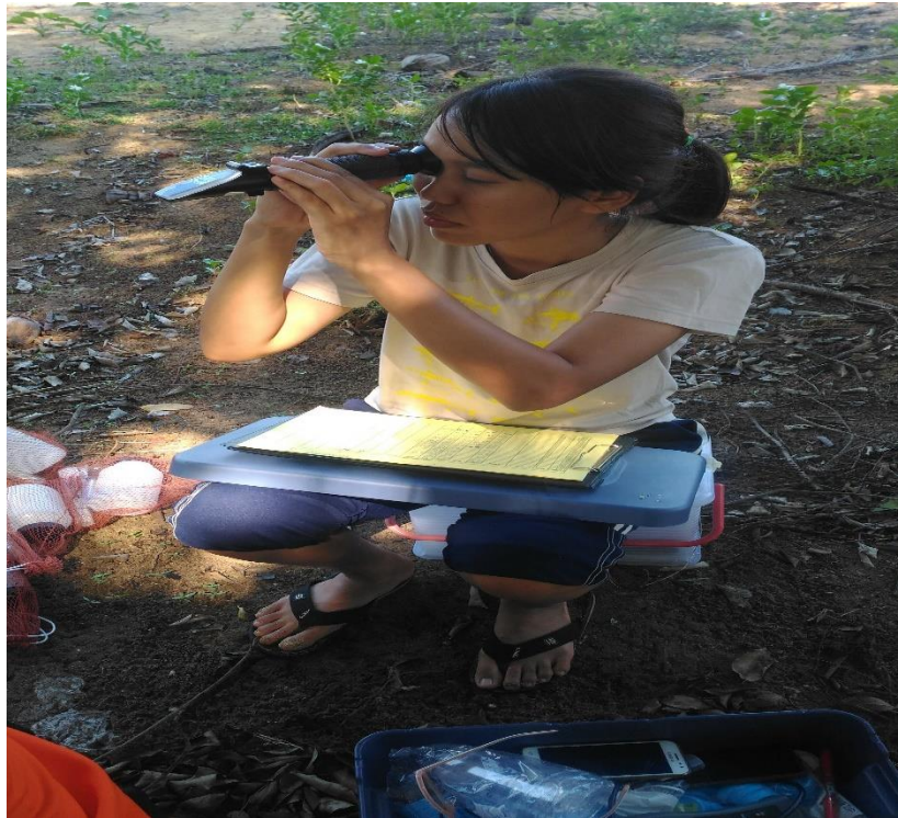
ภาพที่ 3.10 การวัดค่าความเค็มของน้ำทะเลโดยใช้ hand refractometer
