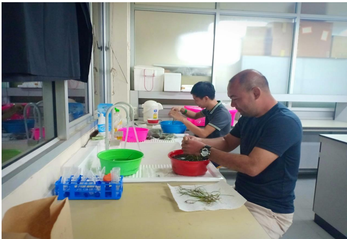
ภาพที่ 3.11 การล้างทำความสะอาดหญ้าทะเลก่อนทำการอบแห้งเพื่อนำไปวิเคราะห์ปริมาณอินทรีย์คาร์บอน
