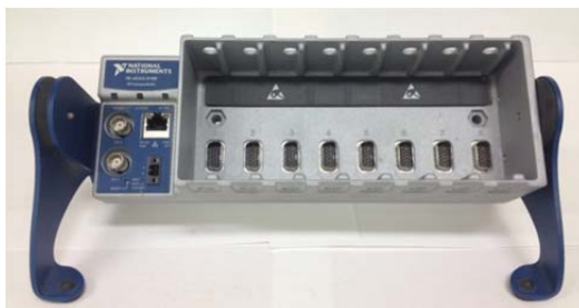
ภาพที่ 3-8 อุปกรณ์รวมสัญญาณ ยี่ห้อ National Instruments NI CDAQ 9178
