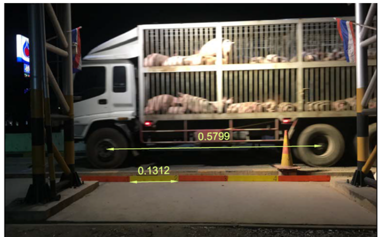
ภาพที่ 3-21 ตัวอย่างภาพนิ่งที่ได้จากการบันทึกที่ด่านตรวจสอบน้ำหนัก เพื่อหาระยะห่างระหว่างเพลานำโปรแกรม AutoCAD
