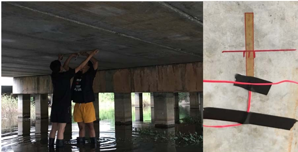
ภาพที่ 3-13 การติดตั้งมาตรฐานวัดความเครียด
