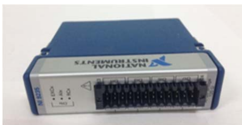
ภาพที่ 3-7 อุปกรณ์แปลงสัญญาณความเครียด
