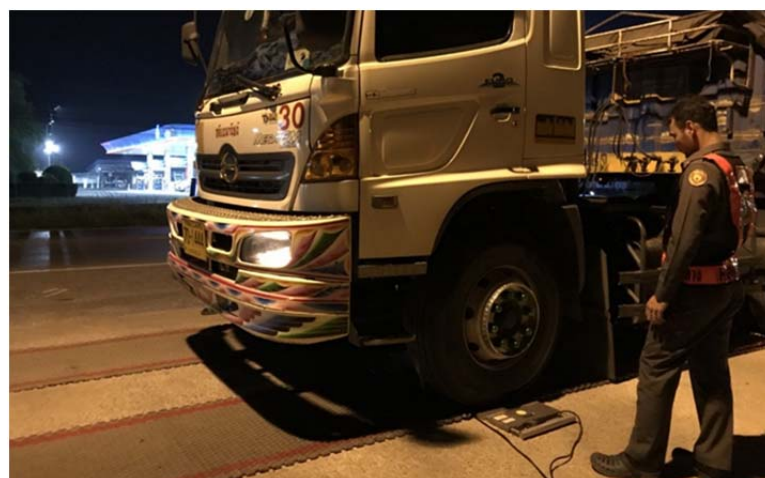
ภาพที่ 3-17 รถบรรทุกขณะชั่งบนตราชั่งน้ำหนักเพลาลูก
