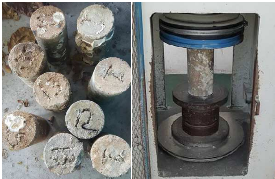
รูปที่ 3.7 การทดสอบกำลังอัดของคอนกรีตผสมเถ้าปลาลมน้ำมันที่อายุแช่น้ำทะเล 7 ปี
