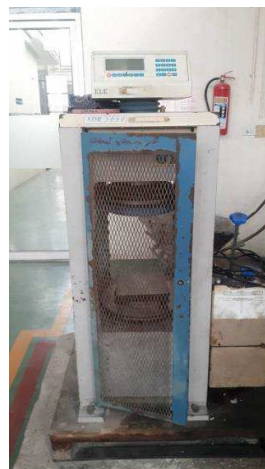
(ฉ) เครื่องทดสอบกำลังอัดคอนกรีต
