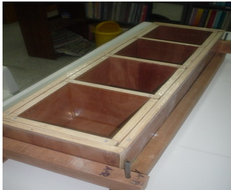
(ค) แบบหล่อตัวอย่างรูปทรงลูกบาศก์ ขนาด 200x200x200 มม 3
