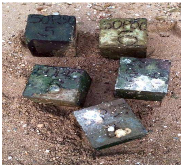
รูปที่ 4.4 สภาพผิวหน้าคอนกรีตเมื่อแช่ในน้ำทะเลเป็นเวลา 7 ปี
