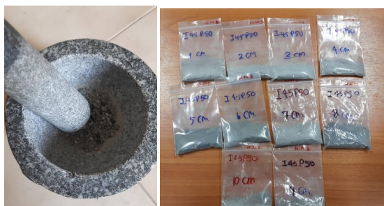
(ข) การบดและเก็บตัวอย่างคอนกรีตเพื่อทดสอบการแทรกซึมของคลอไรด์ รูปที่ 3.4 การเตรียมตัวอย่างคอนกรีตเพื่อทดสอบการแทรกซึมของคลอไรด์
