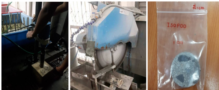
(ก) การเจาะและตัดตัวอย่างคอนกรีต เพื่อให้ทดสอบหาปริมาณคลอไรด์
