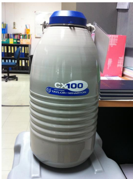
รูปที่ 3 ถังไนโตรเจนเหลวชนิดมีวัสดุดูดซับที่ใช้ในการทดลอง
