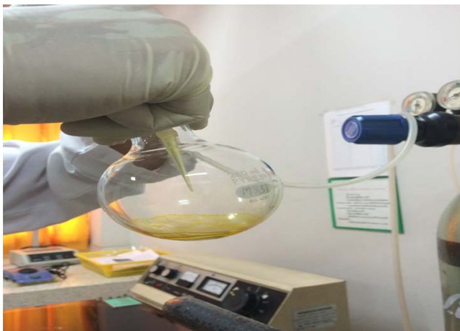
ภาพที่ 17 การ Flow Nitrogen gas ในตัวอย่างสารสกัด
