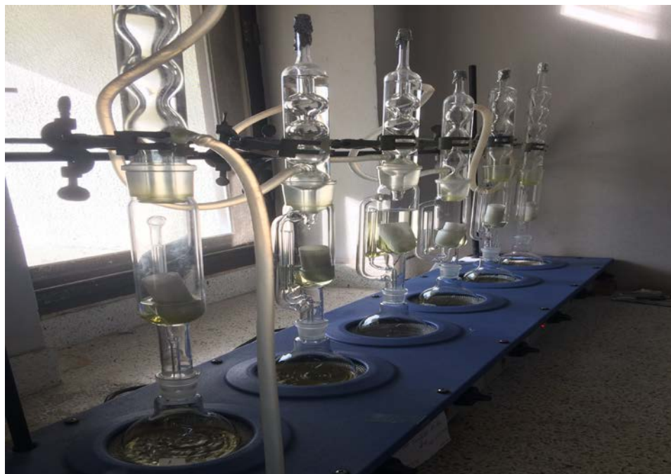
ภาพที่ 20 การสกัดไขมันในเนื้อเยื่อตัวอย่าง แบบต่อเนื่องด้วย Soxhlet extraction
