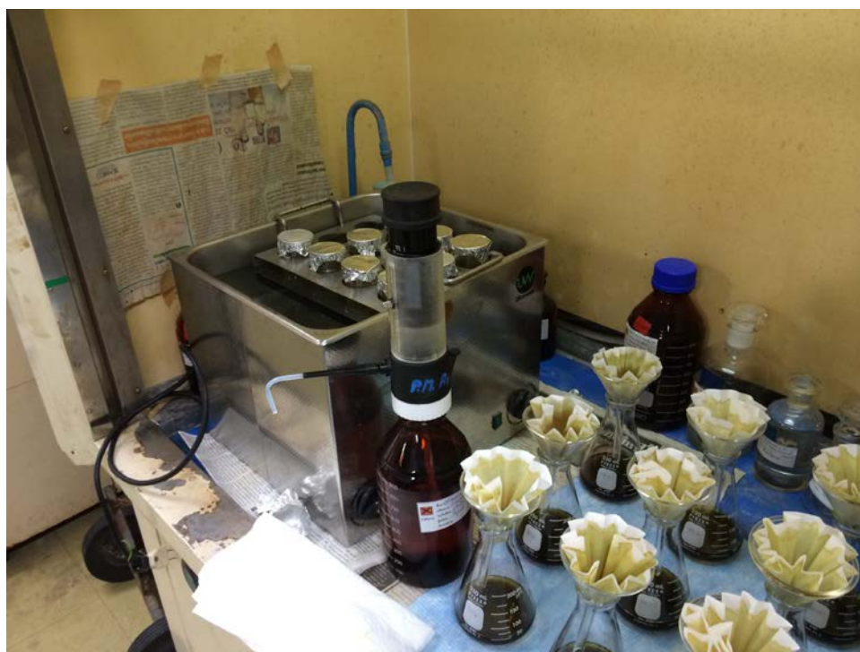
ภาพที่ 12 การสกัดสารฟิเอเอชรวม ในตัวอย่างเนื้อเยื่อและตะกอนดินด้วยเครื่อง Ultrasonic
