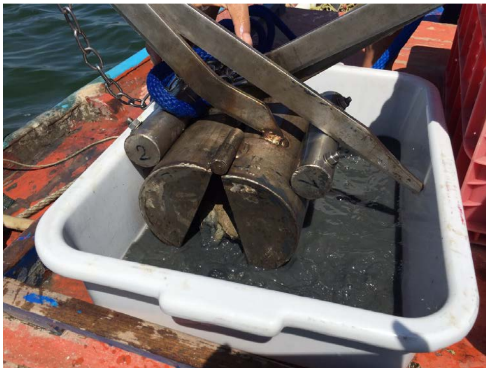
ภาพที่ 9 การเก็บตัวอย่างตะกอนดิน ด้วยกระบอกลักเก็บตัวอย่าง (grab sampling)
