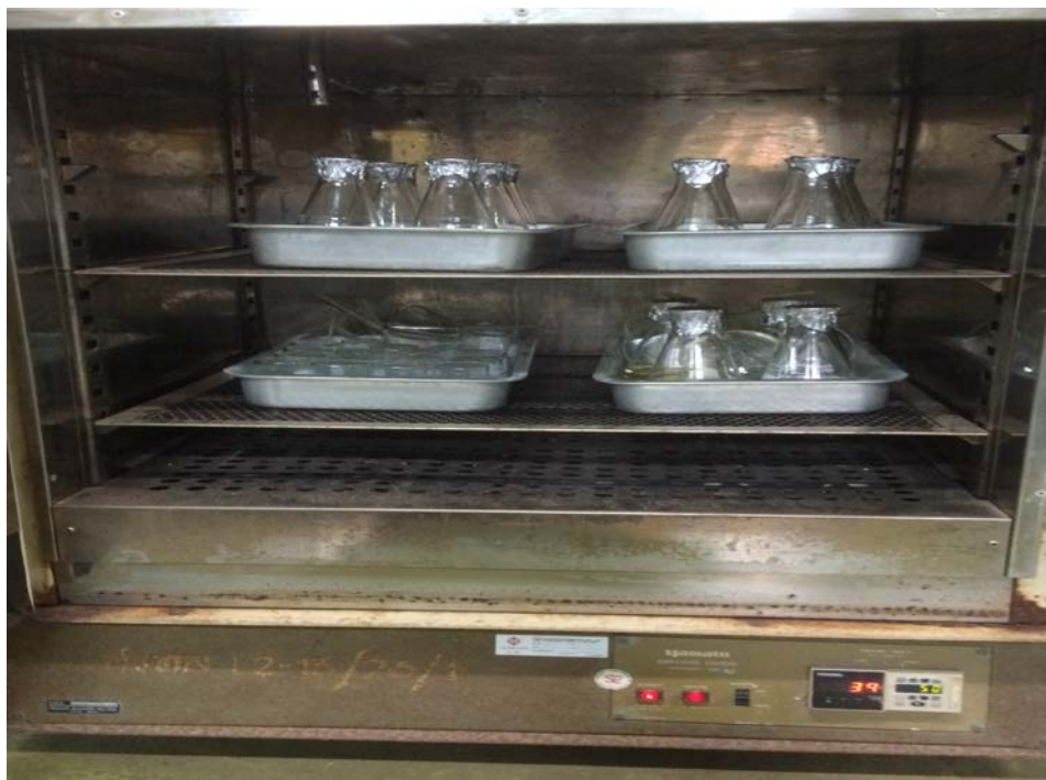
ภาพที่ 13 การบ่มตัวอย่างที่ 50 องศาเซลเซียส เพื่อให้เกิดปฏิกิริยา Saponification
