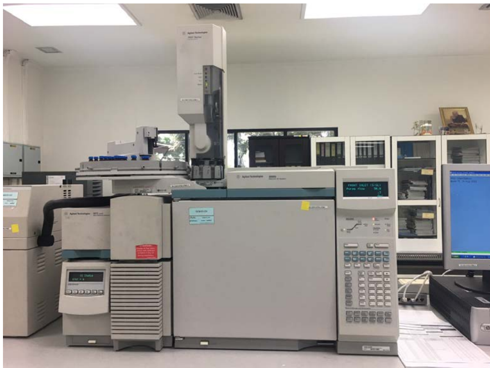
ภาพที่ 19 เครื่อง Gas Chromatograph-Mass Spectrometer (GC-MS) ของบริษัท Agilent รุ่น Agilent 6890N Gas Chromatograph/5970 inert Mass Selective Detector
