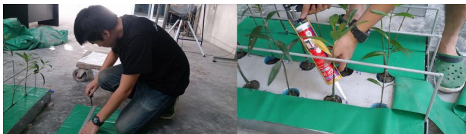
ภาพที่ 3-31 การติดแผ่นผ้าใบที่ผิวหน้าชุดแปลงทดลองคอนกรีต
