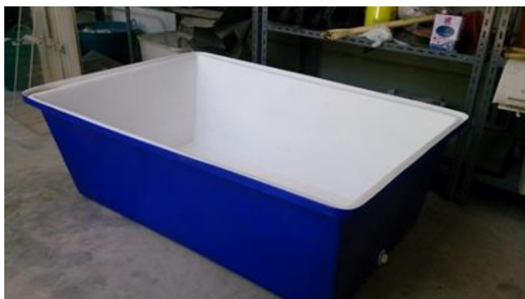
ภาพที่ 3-33 อ่างน้ำควบคุมสำหรับทดลองกรณีที่ไม่ได้รับผลกระทบจากคลื่นและกระแสน้ำ
