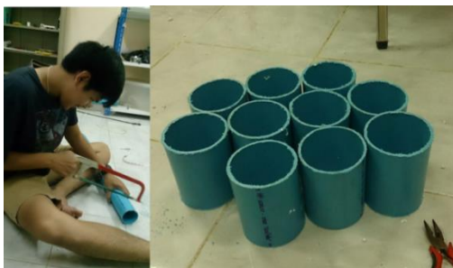
ภาพที่ 3-23 การตัดท่อพีวีซีสำหรับใช้ทำแปลงทดลองคอนกรีต
