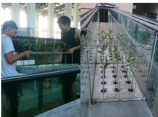
ภาพที่ 3-39 การติดตั้งชุดแปลงทดลองจำลองการปลูกต้นกล้าป่าชายเลนลงในรางจำลองคลื่น
