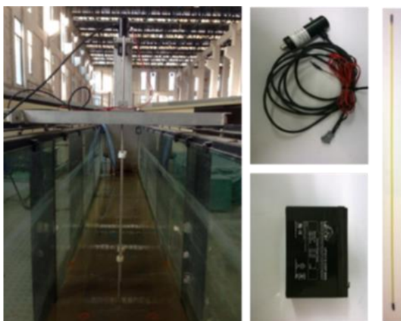
ภาพที่ 3-11 เครื่องวัดความสูงคลื่นแบบวัดการเก็บประจุไฟฟ้า
