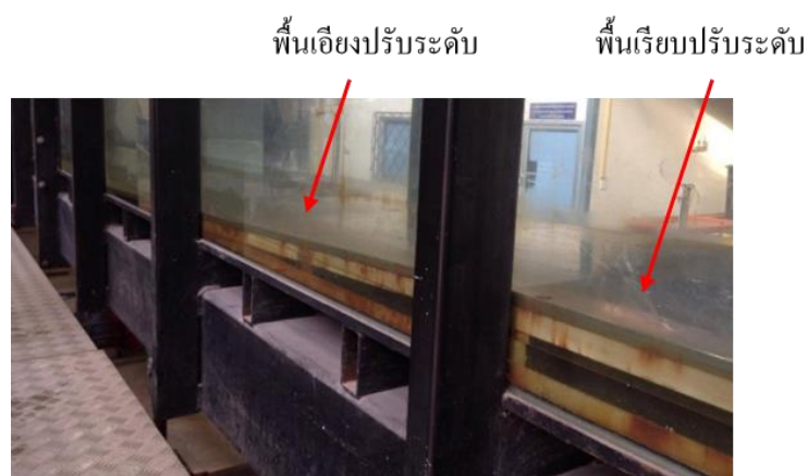
ภาพที่ 3-12 ชุดพื้นแปลงทดลองที่ประกอบไปด้วยพื้นเอียงและพื้นเรียบปรับระดับสำหรับปรับความเสถียรคลื่นก่อนเข้าสู่แปลงทดลอง
