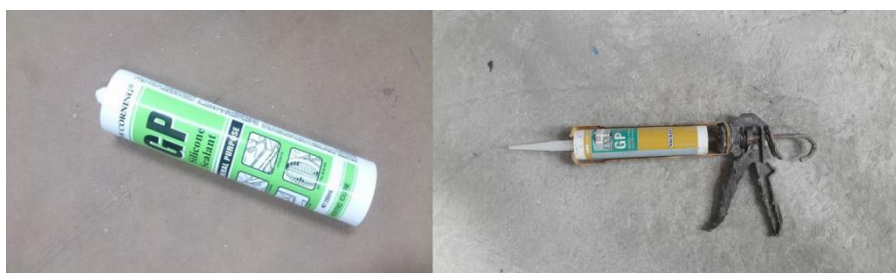
ภาพที่ 3-20 ซีลีโคนสำหรับยึดแผ่นผ้าใบกับผิวหน้าแปลงทดลองคอนกรีต
