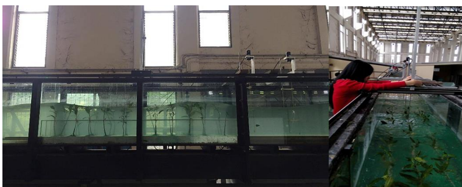
ภาพที่ 3-40 การปั้มน้ำเข้ารางจำลองคลื่นและการวัดค่าระดับน้ำนิ่ง
