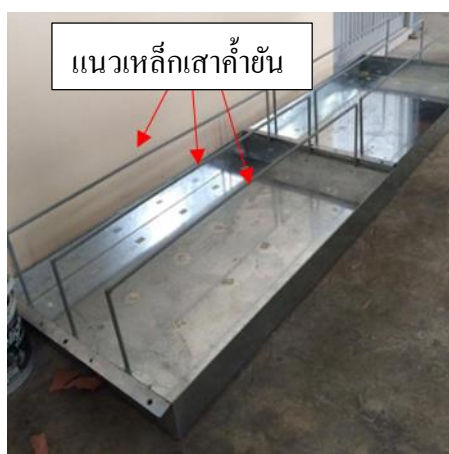
ภาพที่ 3-16 กระบะสังกะสีพร้อมเสาค้ำยันสำหรับใส่แปลงทดลองคอนกรีต
