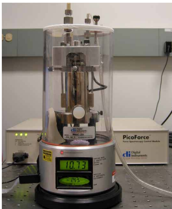
ภาพที่ 2-14 กล้องจุลทรรศน์แรงอะตอม (AFM) แบบ Multimode (เข้าถึงได้จาก : https://sjhsrc.wikispaces.com/AFM?responseToken=d0fe8c810e5c9a263a3ddde790eb69f2 )
