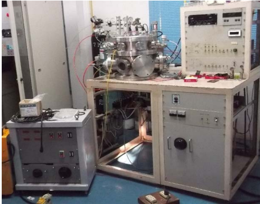
ภาพที่ 3-1 เครื่องเคลือบฟิล์มบางในสุญญากาศระบบ ดีซี แมกนีตรอน โคสปีดเตอริงที่ใช้ในงานวิจัย
