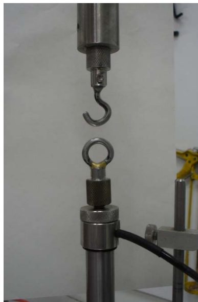
รูปที่ 3-14 ลักษณะของตัวเชื่อมที่ loading ram ที่ได้รับการพัฒนา
