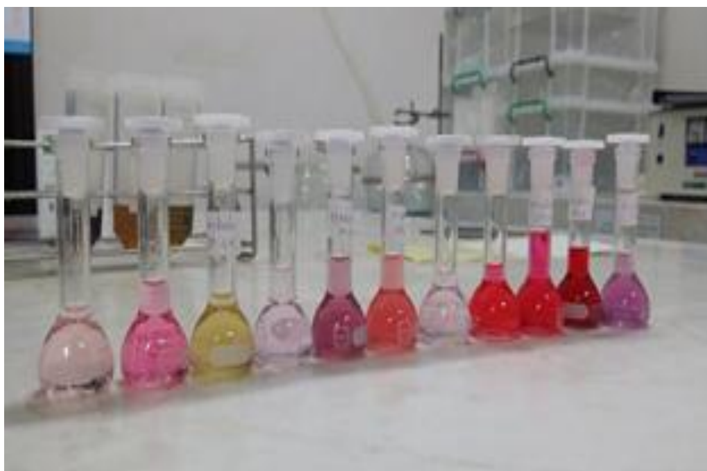
รูปภาพภาคผนวกที่ 14 แสดงวิธีการเตรียมวัดหาค่าดูดกลืนแสงของตัวอย่างสารสี ด้วย UV-vis Spectrophotometer
