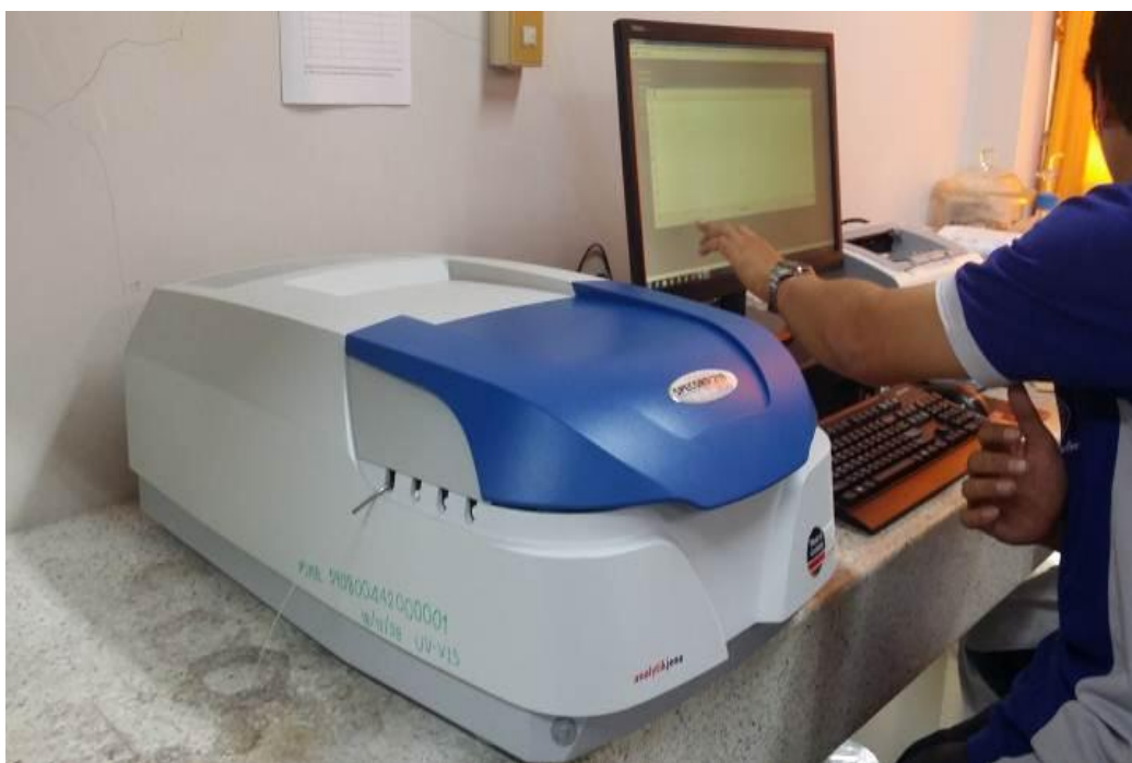
รูปภาพภาคผนวกที่ 14 แสดงวิธีการเตรียมวัดหาค่าดูดกลืนแสงของตัวอย่างสารสี ด้วย UV-vis Spectrophotometer
