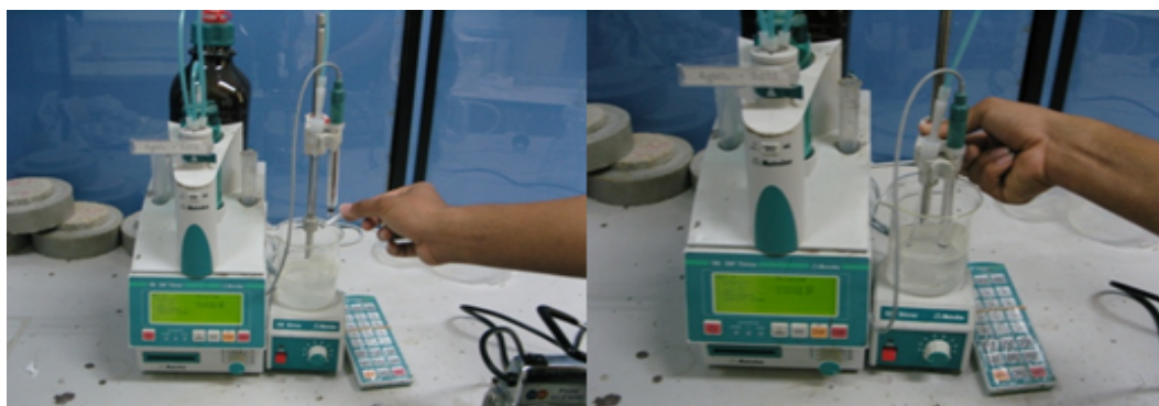
ภาพที่ 3-8 การใช้เครื่อง Auto titration
