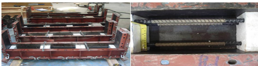
ภาพที่ 3-14 แบบหล่อตัวอย่างทดสอบระยะเวลาการเกิดสนิม
