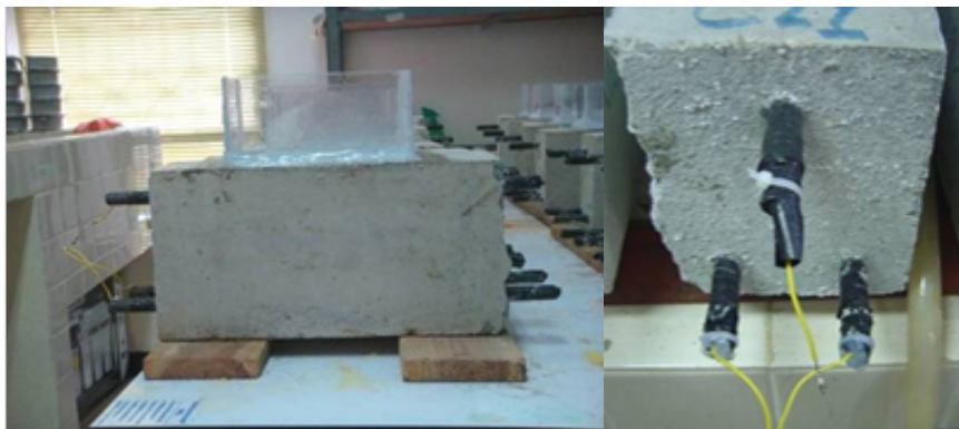
ภาพที่ 3-17 การเตรียมตัวอย่างทดสอบตามมาตรฐาน ASTM G109
