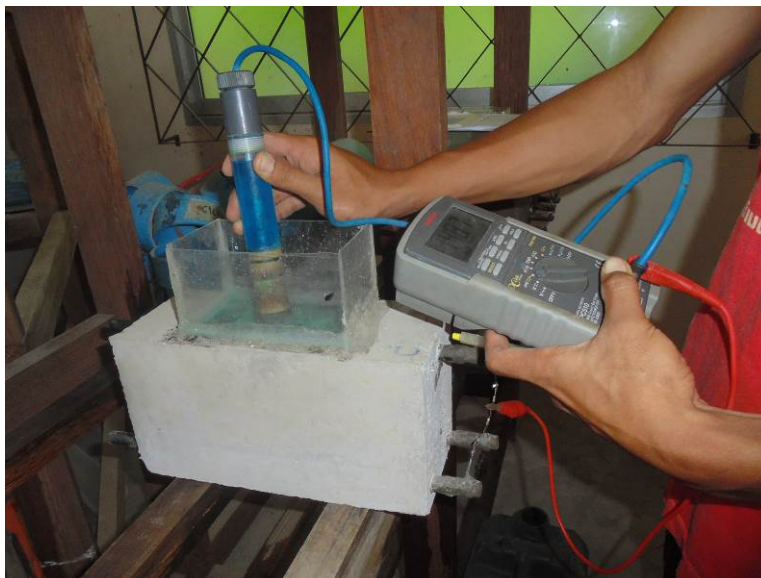
ภาพที่ 3-18 การวัดศักย์ไฟฟ้าครึ่งเซลล์ (Half-cell) ของตัวอย่างทดสอบ
