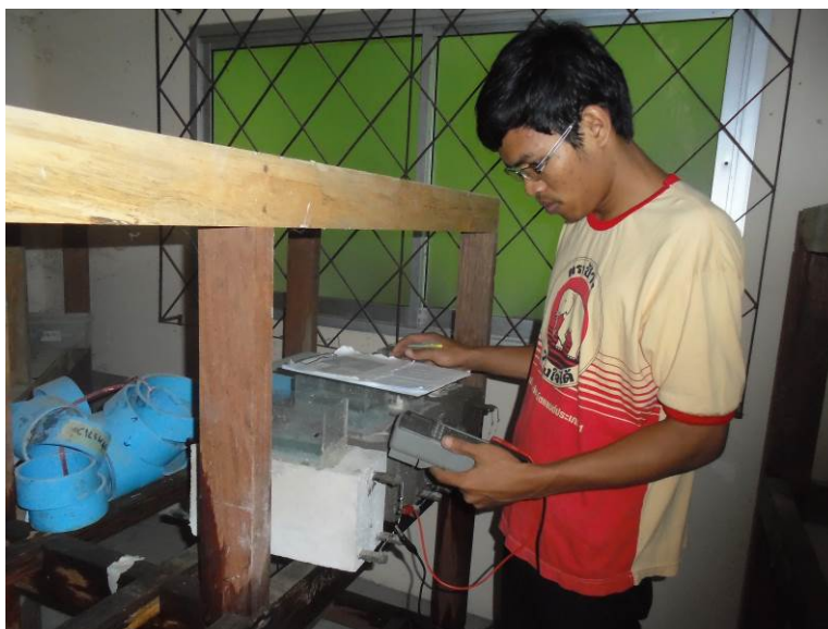
ภาพที่ 3-19 การวัดศักย์ไฟฟ้าที่ไหลผ่านเหล็กเสริมในตัวอย่างทดสอบ
