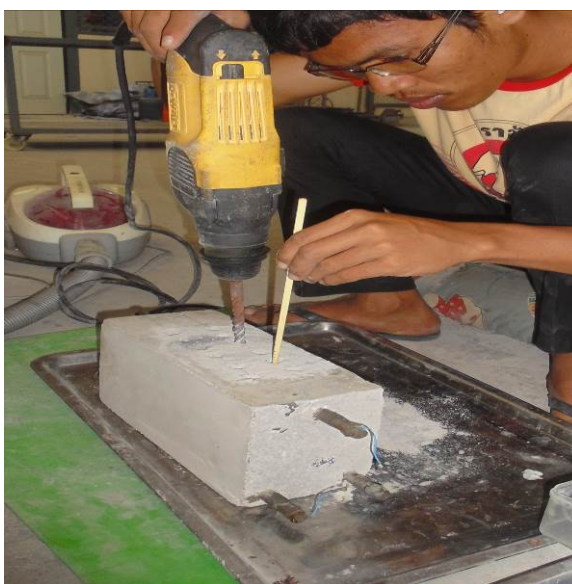
ภาพที่ 3-21 การวัดความลึกที่เจาะเก็บตัวอย่างผงปูน
