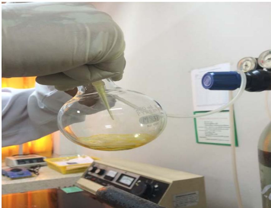
ภาพที่ 7 การ Flow Nitrogen gas ในตัวอย่างสารสกัด
