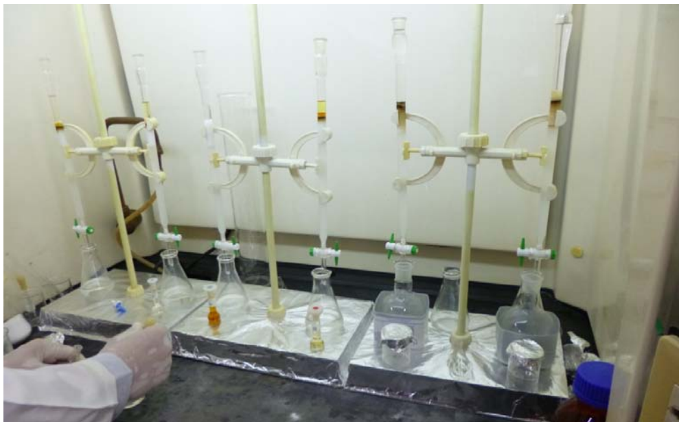
ภาพที่ 5 การแยกเฉพาะส่วนของสารพีเอเอชรวม ด้วยวิธี column chromatography
