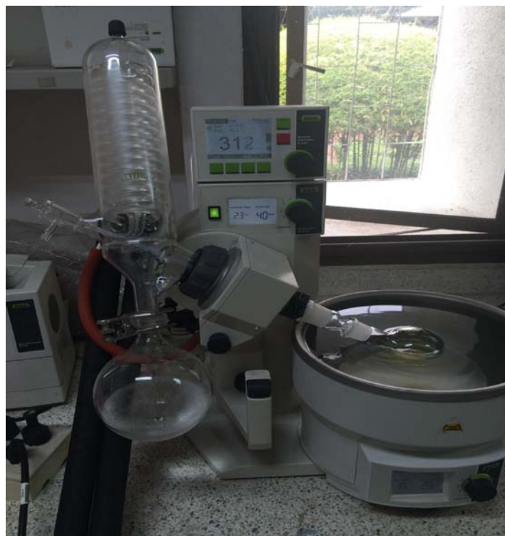
ภาพที่ 6 การระเหยแห้งสารสกัดด้วยเครื่อง Evaporate
