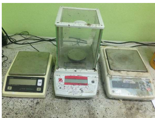
รูปที่ 3.14 เครื่องชั่งน้ำหนักแบบดิจิตอล
