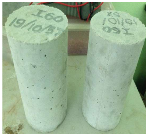
รูปที่ 3.45 ตัวอย่างคอนกรีตทรงกระบอกขนาดเส้นผ่านศูนย์กลาง 10 ซม.
