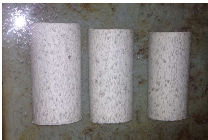
รูปที่ 3.47 คอนกรีตแช่ในสารละลายคลอไรด์
