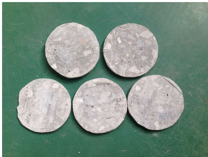
รูปที่ 3.48 คอนกรีตชิ้นหนาประมาณ 1 เซนติเมตร
