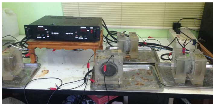
รูปที่ 3.39 ต่อสายจากเครื่องควบคุมศักย์ไฟฟ้าเข้ากับเซลล์ทดสอบ
