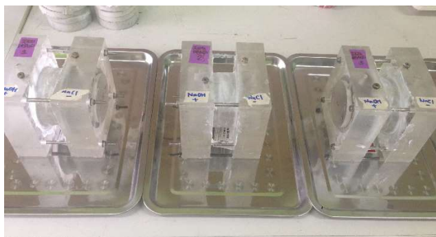
รูปที่ 3.36 นำตัวอย่างมาประกอบเข้ากับเซลล์ทดสอบ
