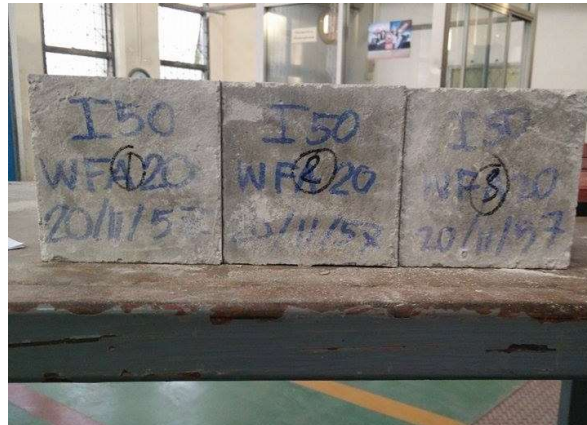
รูปที่ 3.61 ทิ้งคอนกรีตให้แห้งก่อนนำไปทดสอบ
