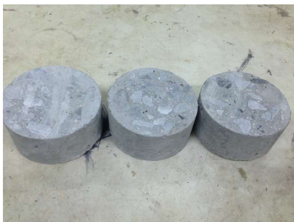
รูปที่ 3.35 ตัวอย่างคอนกรีตที่นำไปตัด
