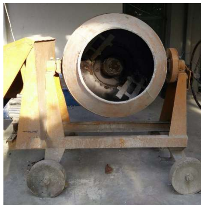
รูปที่ 3.10 เครื่องผสมคอนกรีต
