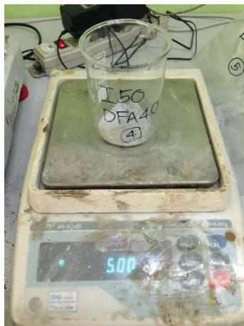
รูปที่ 3.55 คอนกรีตที่บดแล้ว 5 กรัม
