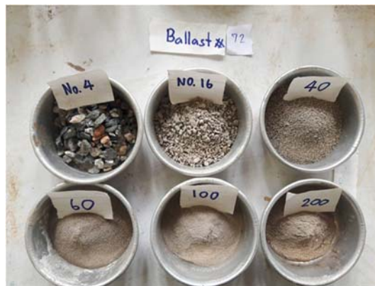
รูปที่ 4-2 visual inspection ของ Ballast Station 72
