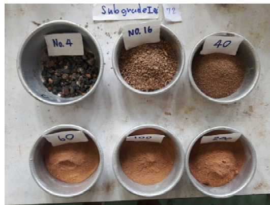
รูปที่ 4-4 visual inspection ของ Subgrade 1 Station 72
