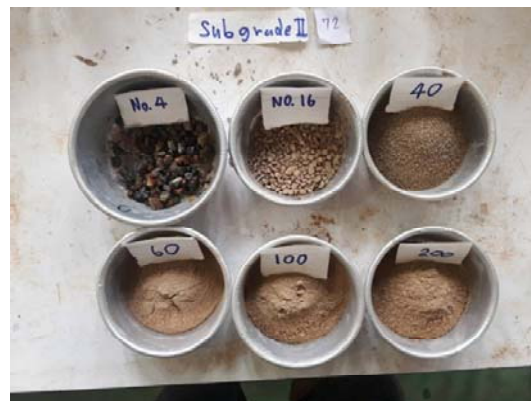
รูปที่ 4-5 visual inspection ของ Subgrade 2 Station 72
