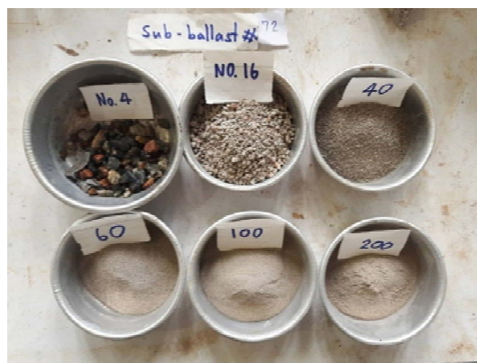
รูปที่ 4-3 visual inspection ของ Sub-ballast Station 72
