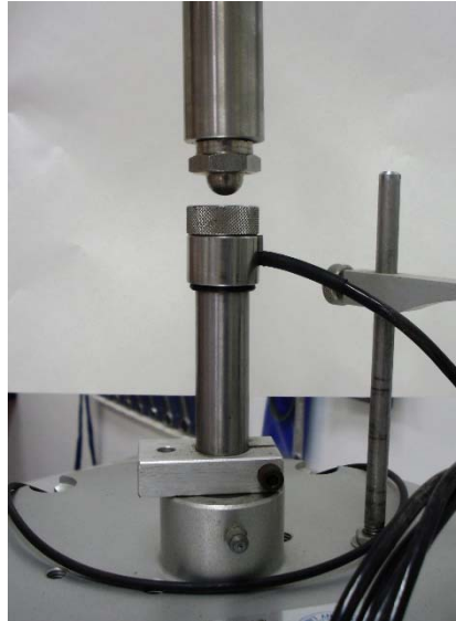
รูปที่ 3-13 ลักษณะของตัวเชื่อมที่ loading ram แบบเดิม
