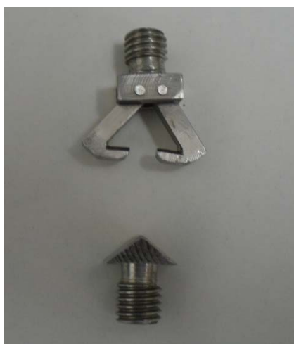
รูปที่ 3-12 ลักษณะของตัวเชื่อมระหว่าง top cap และ loading ram
