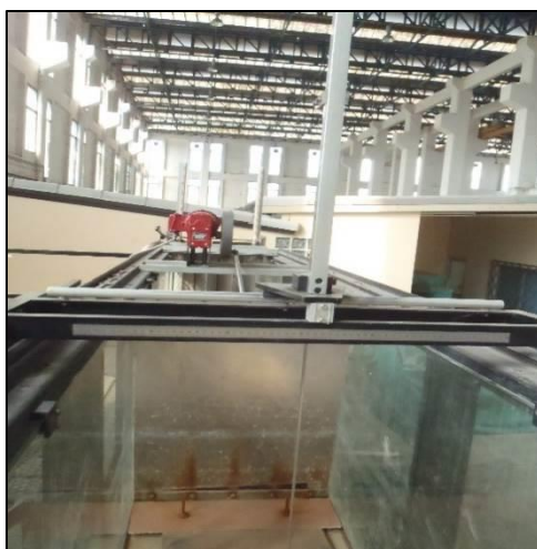
ภาพที่ 3-7 เครื่องวัดระดับน้ำแบบเข็มชี้ (Point Gauge)
