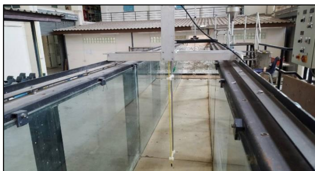
ภาพที่ 3-21 การวัดความสูงของคลื่นก่อนเข้ากระทบโครงสร้าง
