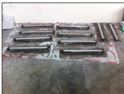
ภาพที่ 3-10 ตัวอย่างแบบหล่อและ ก้อนลูกบาศก์คอนกรีตที่ใช้ในการทดลอง
