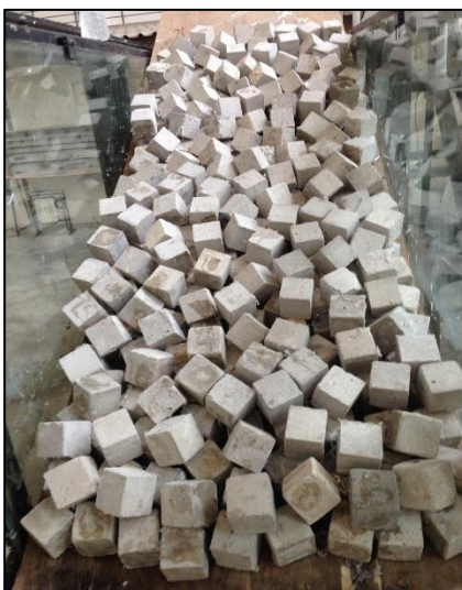
ภาพที่ 3-16 พื้นลูกบาศก์คอนกรีตจัดเรียงแบบสุ่ม
