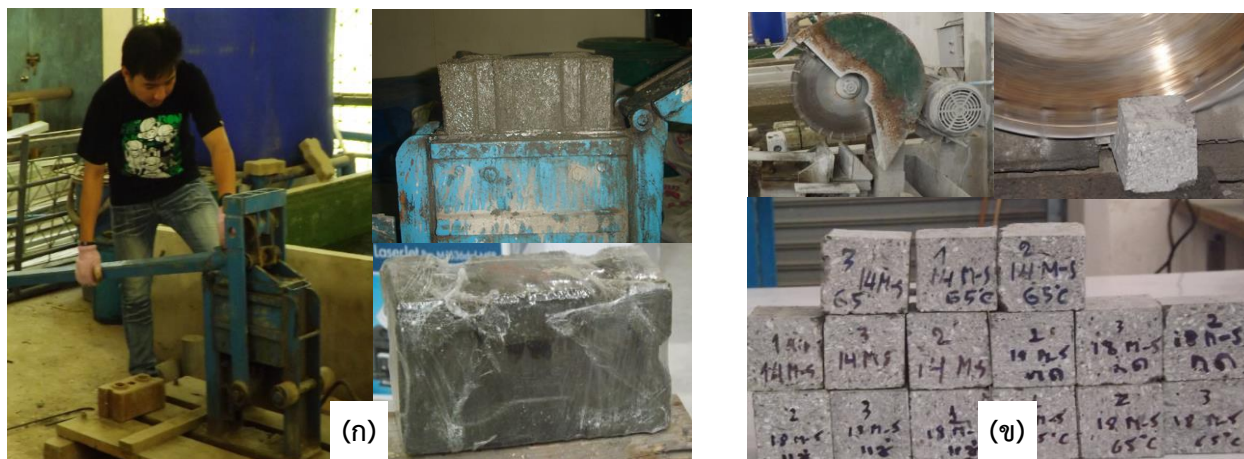
ภาพที่ 1 การเตรียมตัวอย่างจีโอพอลิเมอร์คอนกรีตบล็อกโดย (ก) การอัดคอนกรีตบล็อก (ข) การตัดตัวอย่างเพื่อทดสอบกำลังอัด
