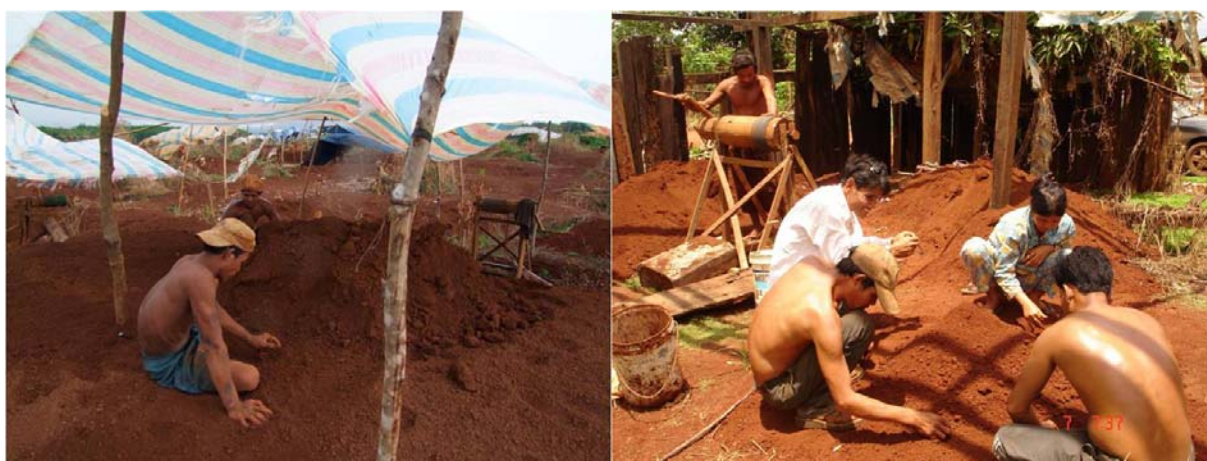
ภาพที่ 7 การทำเหมืองแบบแห้ง โดยการแยกเพทายออกจากดินซึ่งเกิดจากการผุของชั้นหินให้พลอย
