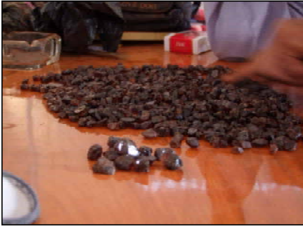
ภาพที่ 10 เพทายก่อนเผาและเพทายหลังเผาแสดงการเปลี่ยนสีของเพทายหลังปรับปรุงคุณภาพด้วยความร้อนในสภาวะไร้ออกซิเจน
