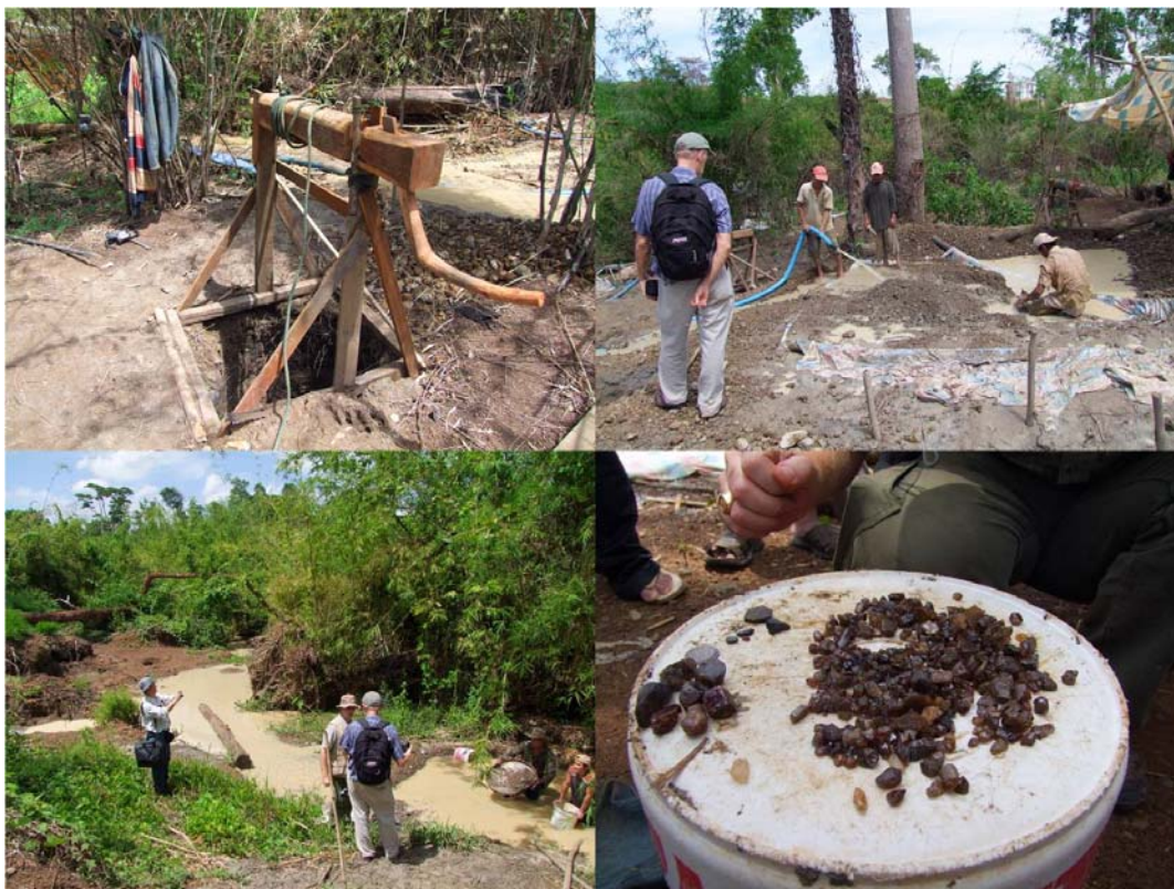
ภาพที่ 6 การทำเหมืองแบบเปียก มีการร่อนแร่โดยใช้น้ำช่วยในการคัดแยกเพทายออกจากตะกอนอื่นๆ
