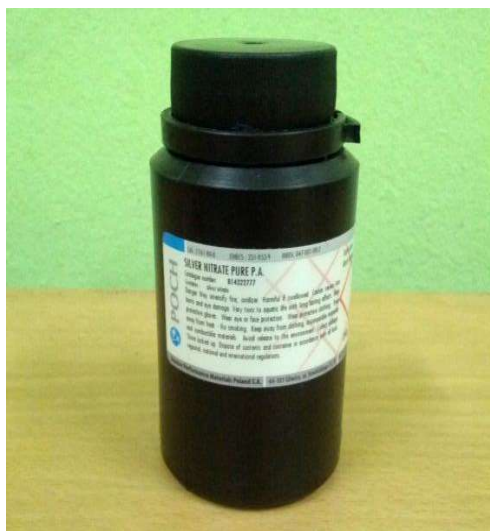
รูปที่ 3.29 สารละลายมาตรฐาน 0.1M ซิลเวอร์ไนเตรท ( \text{AgNO}_3 )
