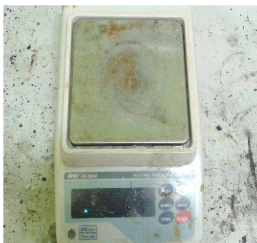
รูปที่ 3.12 เครื่องชั่งน้ำหนักแบบดิจิทัล (Digital balance)
