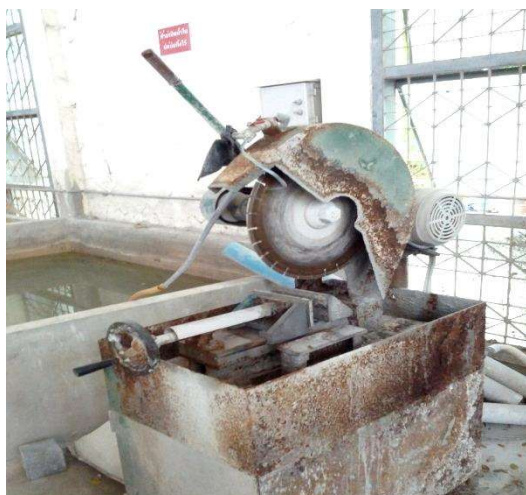
รูปที่ 3.11 เครื่องตัดตัวอย่างคอนกรีต
