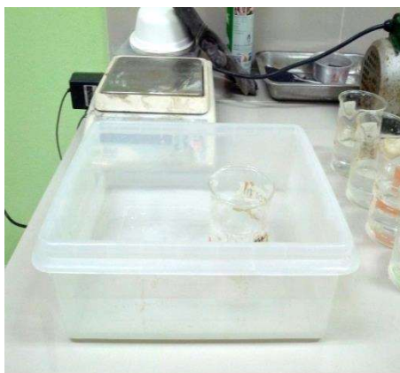
รูปที่ 3.54 ตั้งตัวอย่างทิ้งไว้ให้เย็นโดยแช่ในอ่างน้ำเย็น
