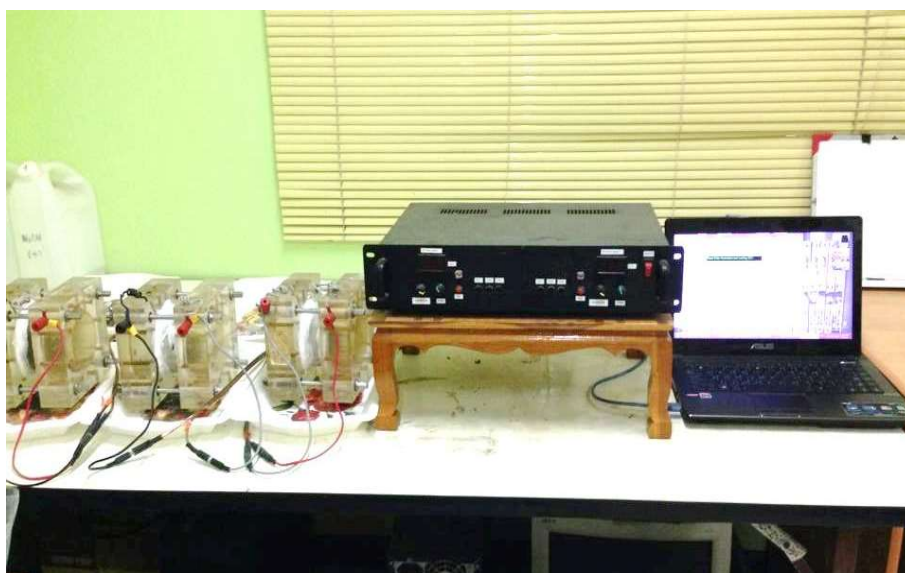
รูปที่ 3.33 เครื่องควบคุมศักย์ไฟฟ้าและคอมพิวเตอร์บันทึกผลต่อเข้ากับเซลล์ทดสอบ
