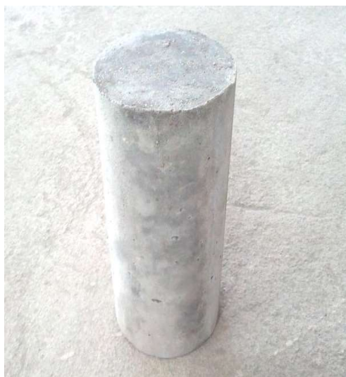
รูปที่ 3.31 ตัวอย่างคอนกรีตทรงกระบอกที่มีขนาด 20 เซนติเมตร \times 10 เซนติเมตร
