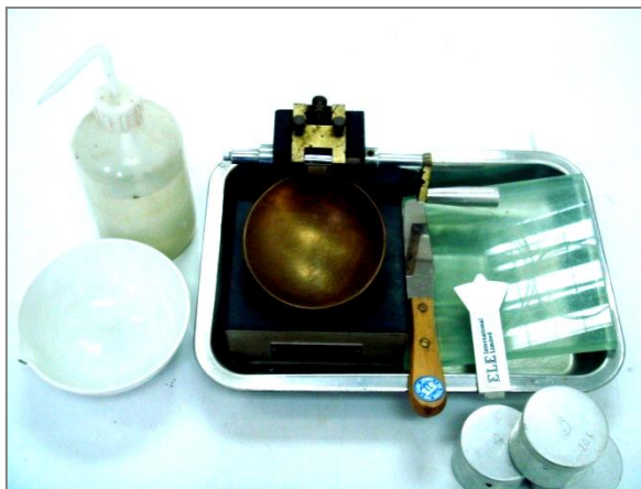
รูปที่ 3.5 ชุดอุปกรณ์หาค่าพิกัดเหลวและพิกัดพลาสติก ตามมาตรฐาน ASTM D 4318
