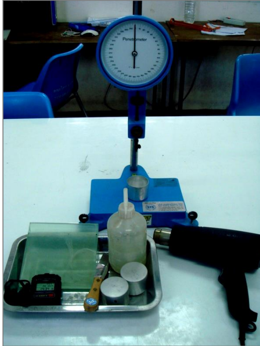
รูปที่ 3.7 ชุดอุปกรณ์หาค่าพิกัดเหลวและพิกัดพลาสติก โดยวิธีตักดิ่ง ตามมาตรฐาน BS 1377-2
