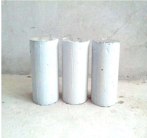
รูปที่ 3.41 ชิ้นตัวอย่างที่เคลือบผิวด้านข้างด้วยอีพ็อกซี
