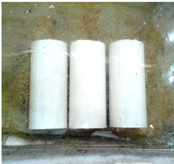
รูปที่ 3.42 การแช่ตัวอย่างในสารละลายเกลือเข้มข้น 5.0%
