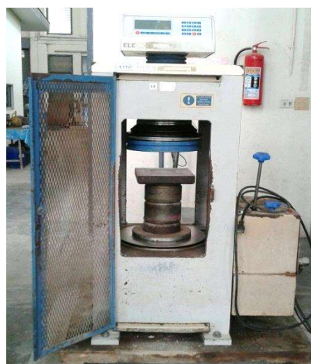
รูปที่ 3.57 เครื่องทดสอบกำลังอัดของคอนกรีต
