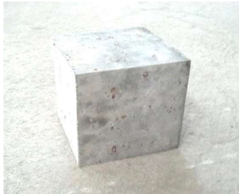
รูปที่ 3.56 คอนกรีตทรงลูกบาศก์
