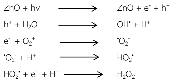
รูปที่ 3.13 ปฏิกิริยาต้านการเจริญของแบคทีเรียโดยอนุภาคนาโนซิงค์ออกไซด์ (Dutta และคณะ, 2012)
