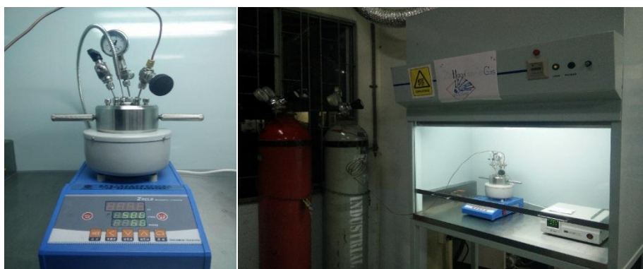
รูปที่ 3.6 รีแอกเตอร์ที่ใช้ในการผลิตไบโอดีเซล
