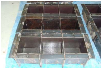
ภาพที่ 3.12 แบบหล่อตัวอย่างคอนกรีตทรง ลูกบาศก์ขนาด 20x20x20 เซนติเมตร 3
