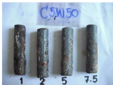
ภาพที่ 3.14 เหล็กกลมผิวเรียบขนาดเส้นผ่าน ศูนย์กลาง 12 มิลลิเมตร ยาว 50 มิลลิเมตร
