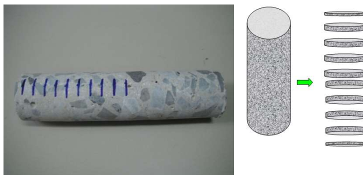
ภาพที่ 3.21 แท่งตัวอย่างคอนกรีตที่เจาะออกมา และการตัดแท่งตัวอย่าง
