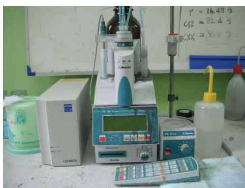
ภาพที่ 3.23 เครื่องไตเตรทอัตโนมัติ ด้วยวิธีจุดยุติทางศักย์ไฟฟ้า
