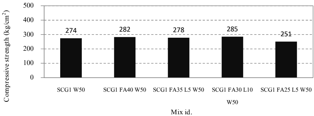
(ข) คอนกรีตที่อัตราส่วนน้ำต่อวัสดุประสาน 0.50
