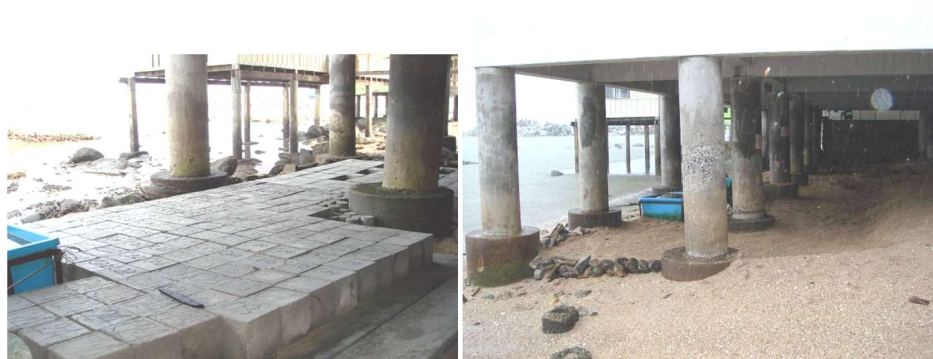
ภาพที่ 3.19 บริเวณวางตัวอย่างและตัวอย่างคอนกรีตที่ใช้ทดสอบ ใต้ศาลาวัด โคมุทวัฒนาราม
