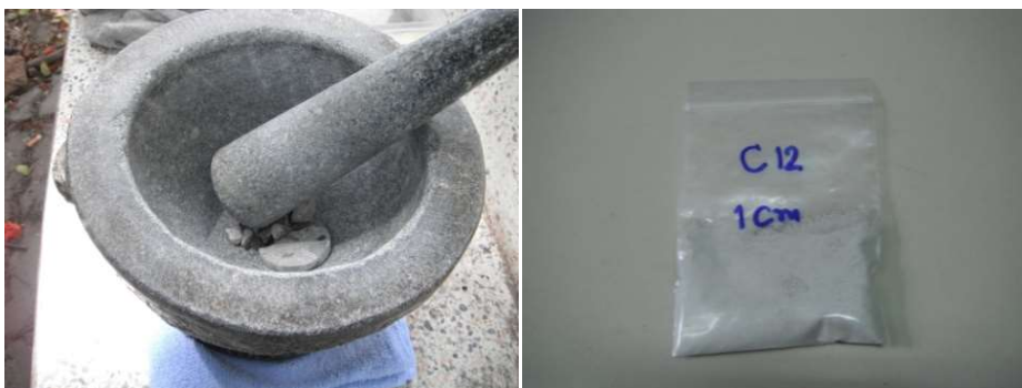
ภาพที่ 3.22 ครกใช้บดตัวอย่าง และผงตัวอย่างที่ถูบดแล้ว
