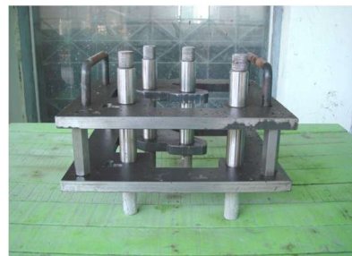
ภาพที่ 3.13 อุปกรณ์กำหนดระยะคอนกรีตหุ้ม เหล็ก
