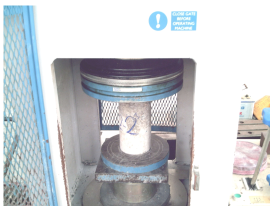
ภาพที่ 3.23 การทดสอบกำลังรับแรงอัด ( f'_c ) ของตัวอย่างคอนกรีต
