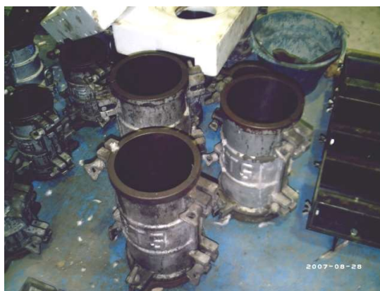
ภาพที่ 3.5 แบบหล่อตัวอย่างทรงกระบอก ขนาดเส้นผ่าศูนย์กลาง 15 เซนติเมตร และสูง 30 เซนติเมตร
