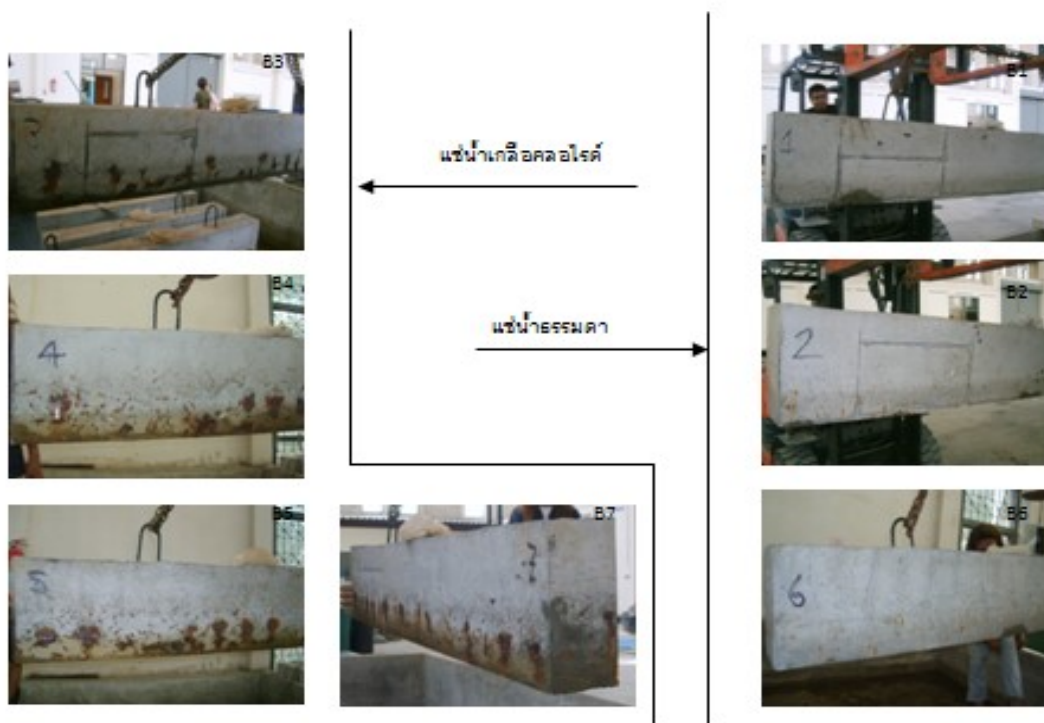
ภาพความเสียหายของคานทดสอบ เมื่อระยะเวลาผ่านไป 8 เดือน
