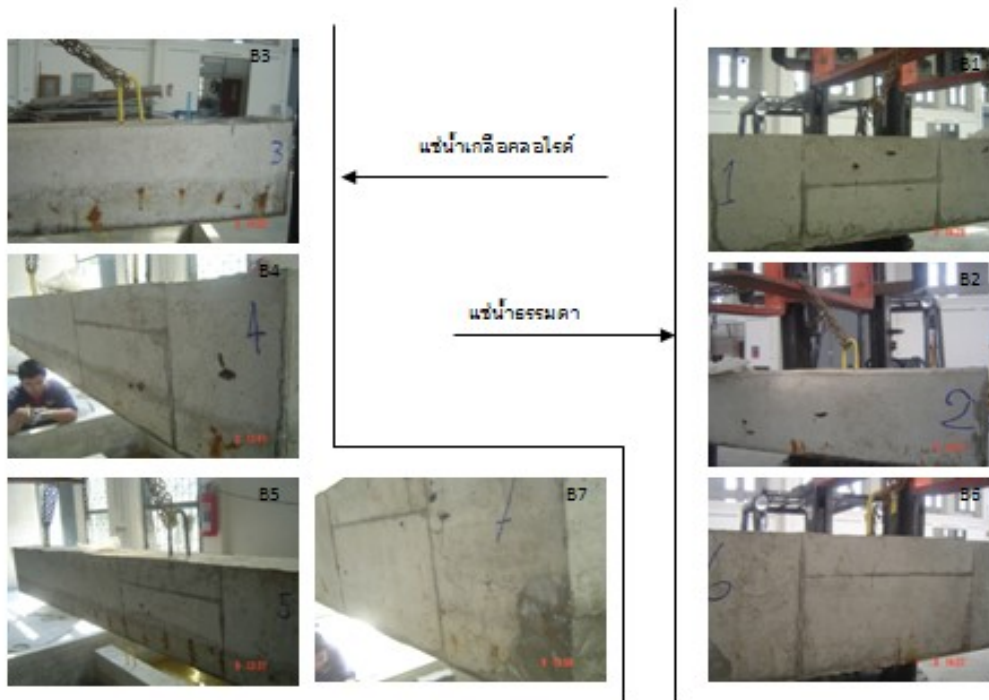
ภาพความเสียหายของคานทดสอบ เมื่อระยะเวลาผ่านไป 1 เดือน
