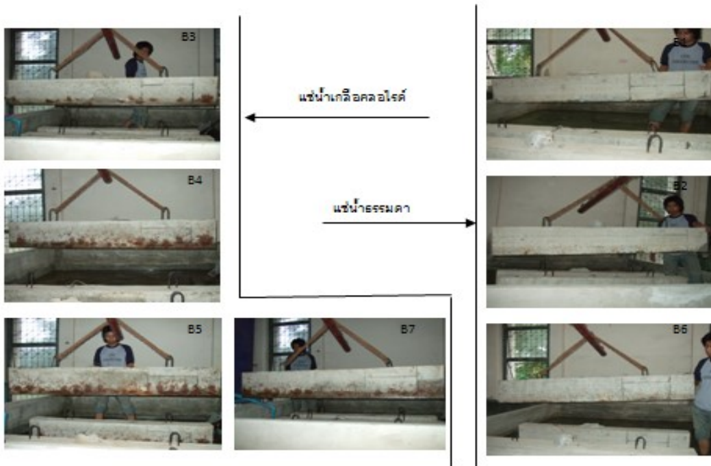
ภาพความเสียหายของคานทดสอบ เมื่อระยะเวลาผ่านไป 20 เดือน
