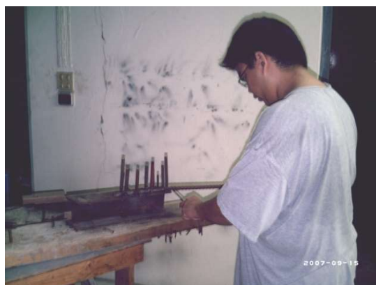
ภาพที่ 3.26 การตัดเหล็กเสริมเพื่อใช้ทำคานตัวอย่างทดสอบ
