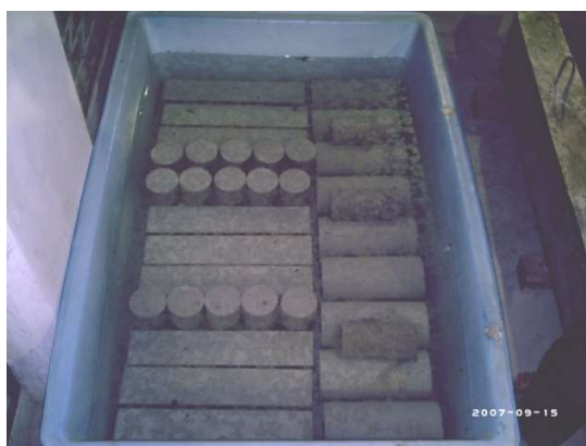
ภาพที่ 3.41 การบ่มตัวอย่างทดสอบแบบขังน้ำ
