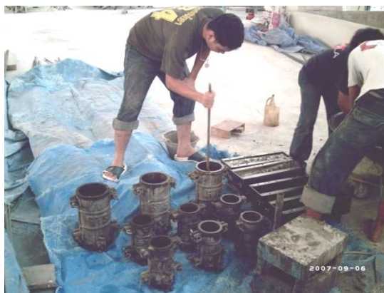
ภาพที่ 3.38 การเก็บตัวอย่างคอนกรีตเพื่อใช้ในการทดสอบกำลังรับแรงที่ใช้ในการทดลอง
