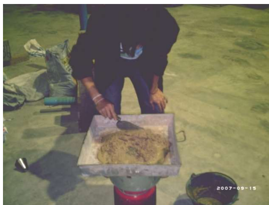
รูป 3.30 การหาค่า Absorption ของทรายที่ใช้ในการผสม
