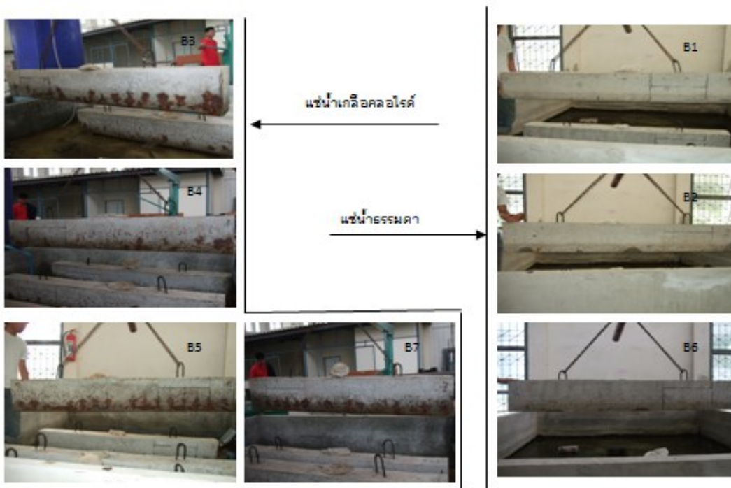
ภาพความเสียหายของคานทดสอบ เมื่อระยะเวลาผ่านไป 18 เดือน
