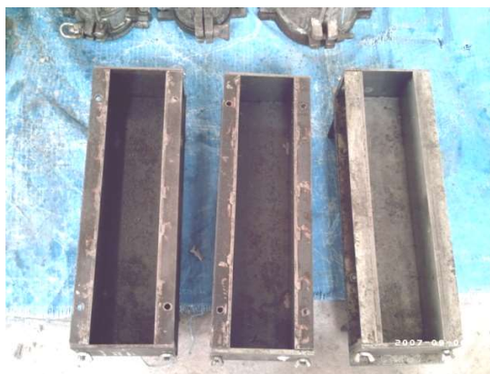
รูป 3.34 แบบทดสอบกำลังรับแรงดัดของคอนกรีตที่ใช้ในการทดลอง
