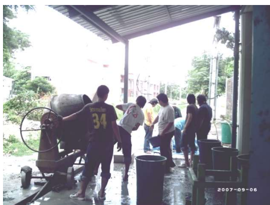
ภาพที่ 3.35 การผสมคอนกรีตที่ใช้ในการหล่อคานตัวอย่างทดลอง
