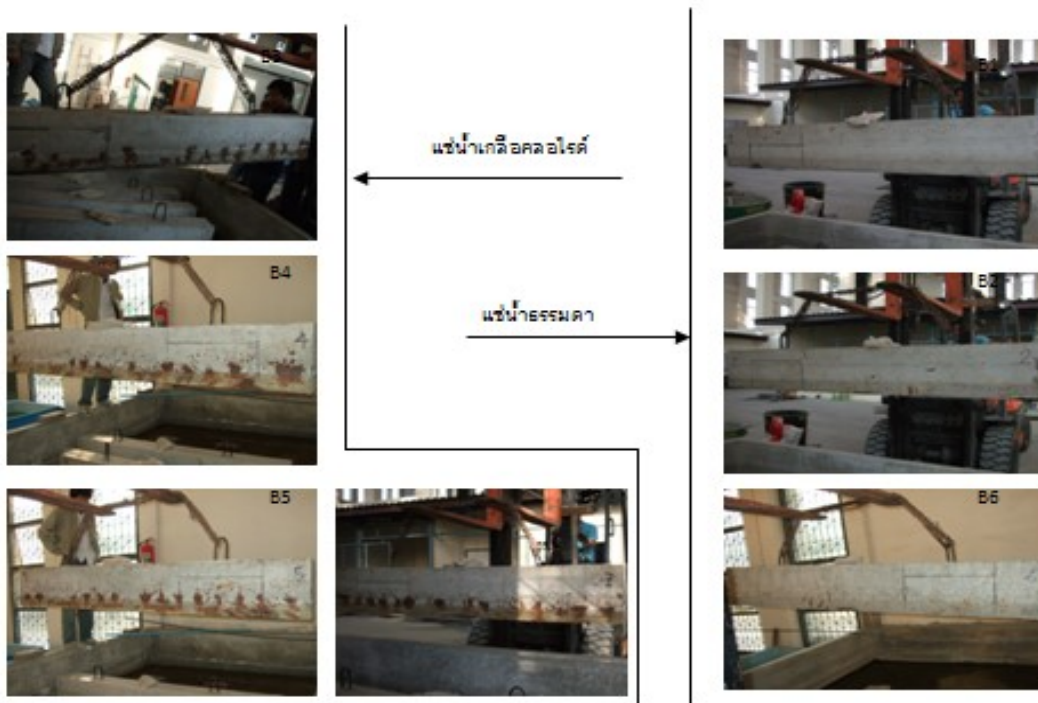
ภาพความเสียหายของคานทดสอบ เมื่อระยะเวลาผ่านไป 14 เดือน
