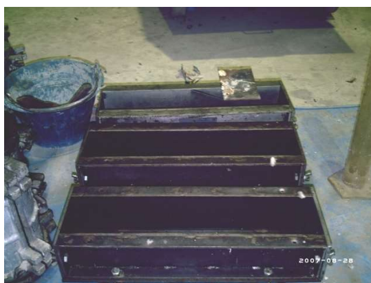
ภาพที่ 3.3 แบบหล่อตัวอย่างคานขนาด 10 x 10 x 50 เซนติเมตร
