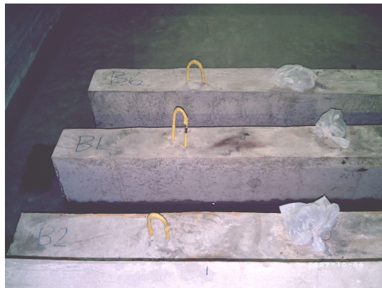
ภาพที่ 3.45 คานทดสอบที่แช่ในน้ำเปล่า
