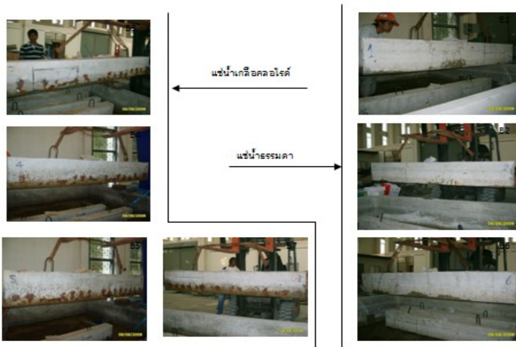
ภาพความเสียหายของคานทดสอบ เมื่อระยะเวลาผ่านไป 11 เดือน
