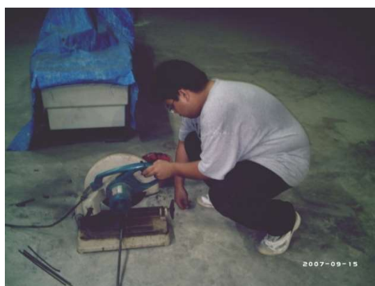
ภาพที่ 3.25 การตัดเหล็กเสริมเพื่อใช้ทำคานตัวอย่างทดสอบ
