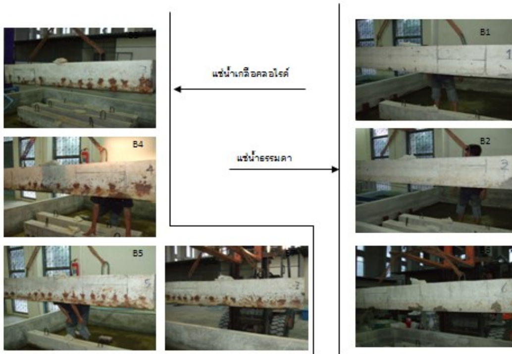
ภาพความเสียหายของคานทดสอบ เมื่อระยะเวลาผ่านไป 13 เดือน
