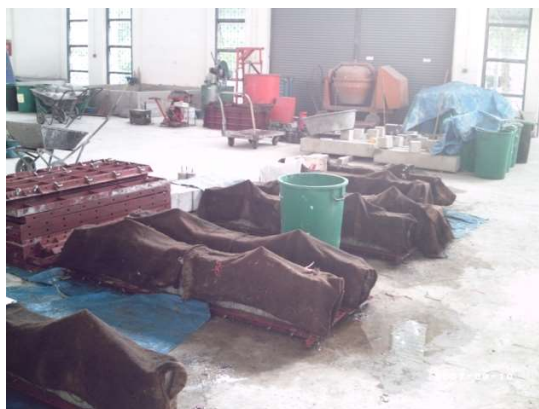
ภาพที่ 3.40 การบ่มตัวอย่างกานทดสอบด้วยกระสอบ
