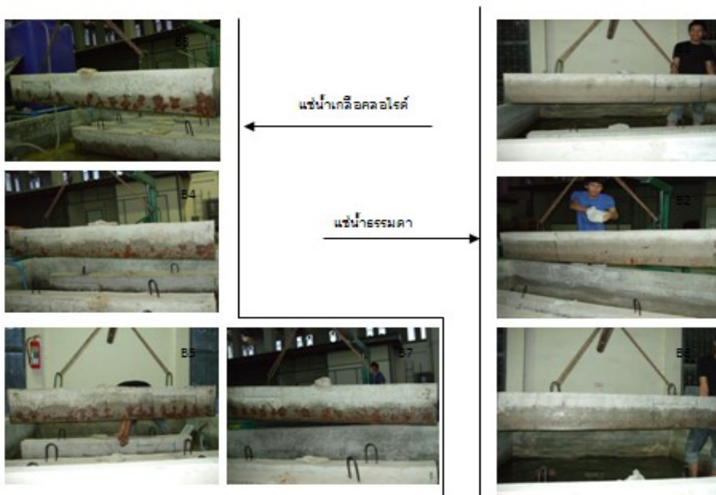
ภาพความเสียหายของคานทดสอบ เมื่อระยะเวลาผ่านไป 16 เดือน
