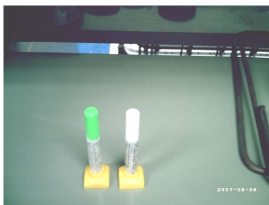
ภาพที่ 3.17 กาวติดอุปกรณ์วัดหน่วยการยึดหดของเหล็กเสริม
