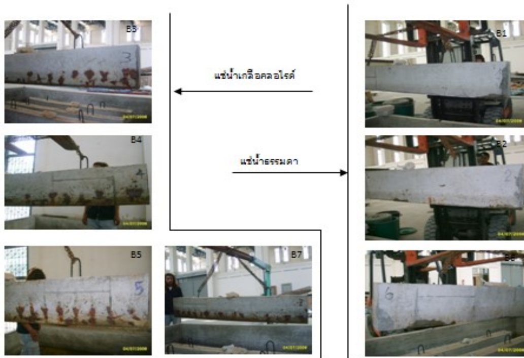
ภาพความเสียหายของคานทดสอบ เมื่อระยะเวลาผ่านไป 9 เดือน
