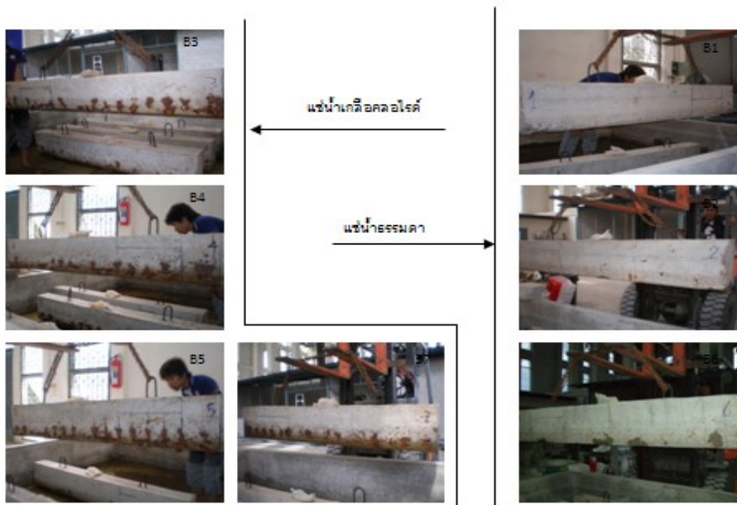
ภาพความเสียหายของคานทดสอบ เมื่อระยะเวลาผ่านไป 12 เดือน
