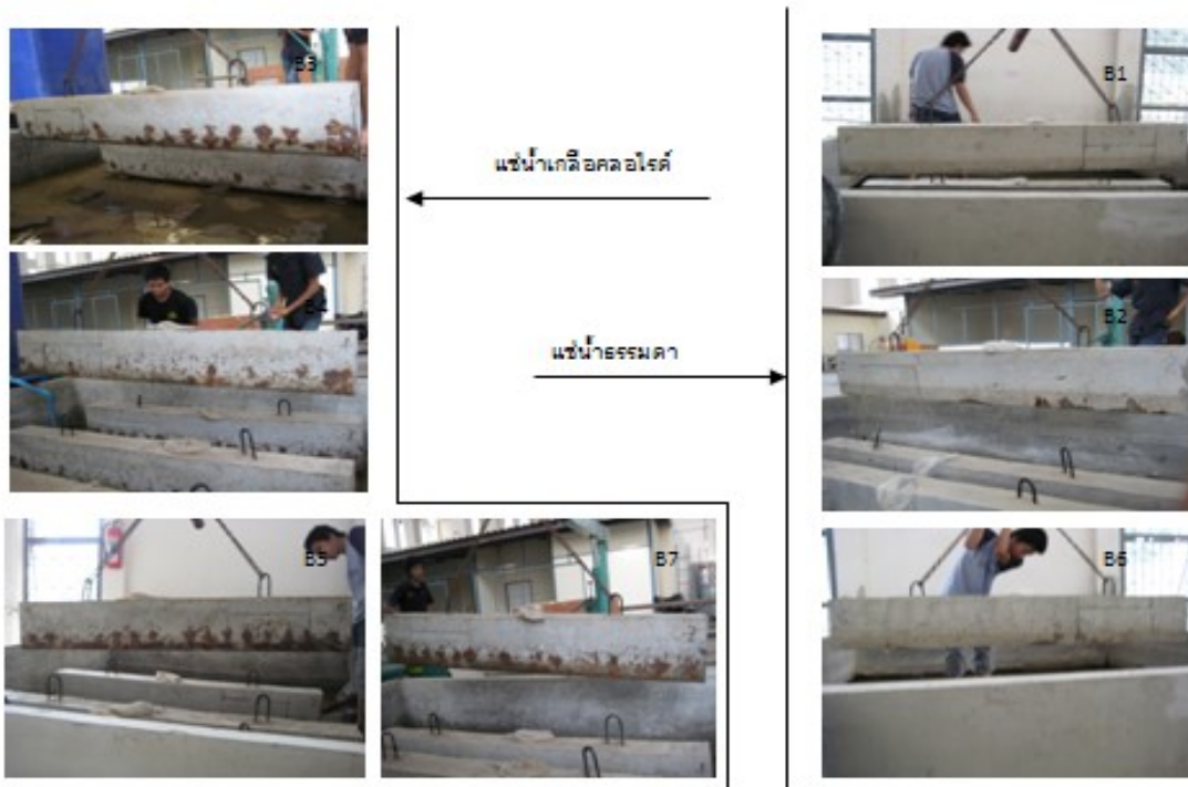
ภาพความเสียหายของคานทดสอบ เมื่อระยะเวลาผ่านไป 17 เดือน
