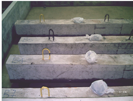
ภาพที่ 3.44 คานทดสอบที่แช่ในสภาวะแวดล้อมเกลือคลอไรด์
