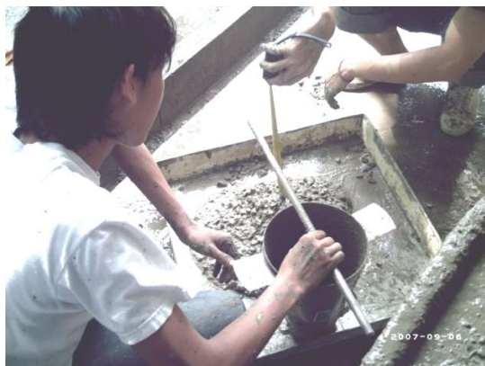
ภาพที่ 3.36 การหาค่าการยุบตัวของคอนกรีตที่ใช้ในการหล่อคานตัวอย่างทดลอง
