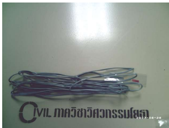
ภาพที่ 3.14 อุปกรณ์วัดหน่วยการยืดหดของเหล็กเสริม
