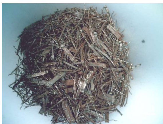
ภาพที่ 3.1 ลักษณะของเส้นใยเหล็ก (Steel fiber)
