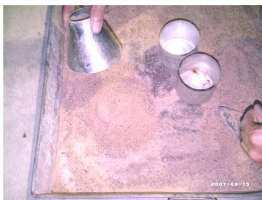
ภาพที่ 3.31 การทดสอบ Cone Sand Test เพื่อหาค่า Absorption ของทรายที่ใช้ในการทดลอง
