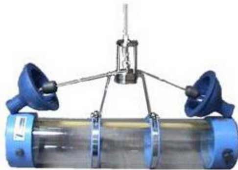
ภาพที่ 2 - 3 กระจบอเก็บน้ำแบบ Van Dorn ใช้ในการเก็บตัวอย่างน้ำเพื่อศึกษาปริมาณธาตุอาหารอนินทรีย์บริเวณปากน้ำแฉมหนู
