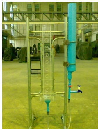
รูปที่ 3-5 อุปกรณ์ทดลองการไหลซึมผ่านแบบใช้กระบอกทรงสูง (One dimensional column)
