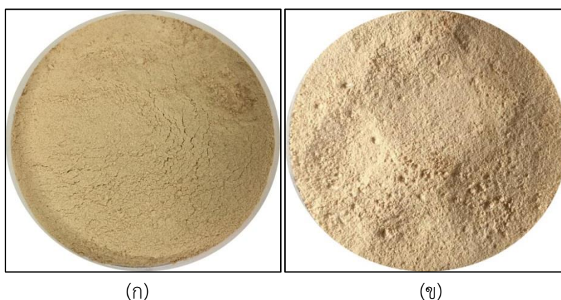
ภาพที่ 4-4 ลักษณะปรากฏของส่วนเหลือทิ้งเห็ดขอนขาวผงจากการทำให้แห้งด้วย (ก) ตู้อบลมร้อน และ (ข) ตู้อบสุญญากาศ
