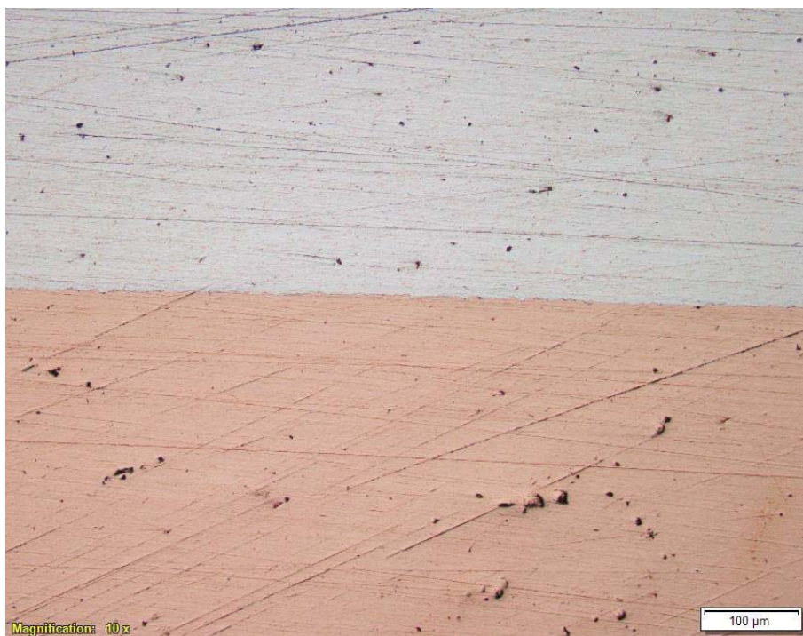
รูปที่ ก-15 ทองแดง/เงินสเตอร์ลิง อุณหภูมิ 750°C บรรยากาศแบบบริดจ์ขึ้น ยืนอุณหภูมิ 15 ชั่วโมง
