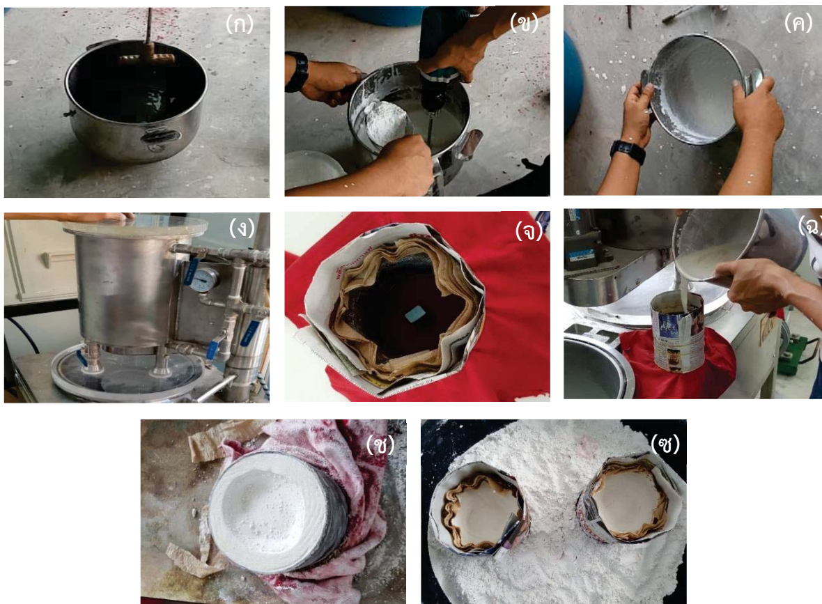
รูปที่ 17 ขั้นตอนการเตรียมกระบอกรูปหล่อ
