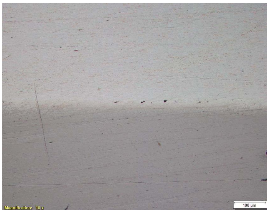
รูปที่ ก-17 แพลเลเดียม500/เงินสเตอร์ลิง อุณหภูมิ 750°C บรรยากาศแบบบริดจ์ชั้น ยืนอุณหภูมิ 10 ชั่วโมง
