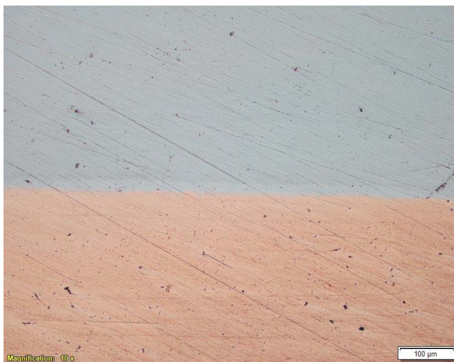
รูปที่ ก-1 ทองแดง/แพลเลเดียม500 อุณหภูมิ 750°C บรรยากาศแบบออกซิเดชัน ยืนอุณหภูมิ 5 ชั่วโมง
