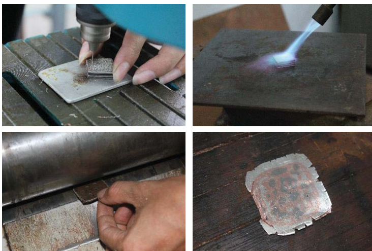
รูปที่ 25 ขั้นตอนการสร้างลวดลายบนแผ่นโลหะ
