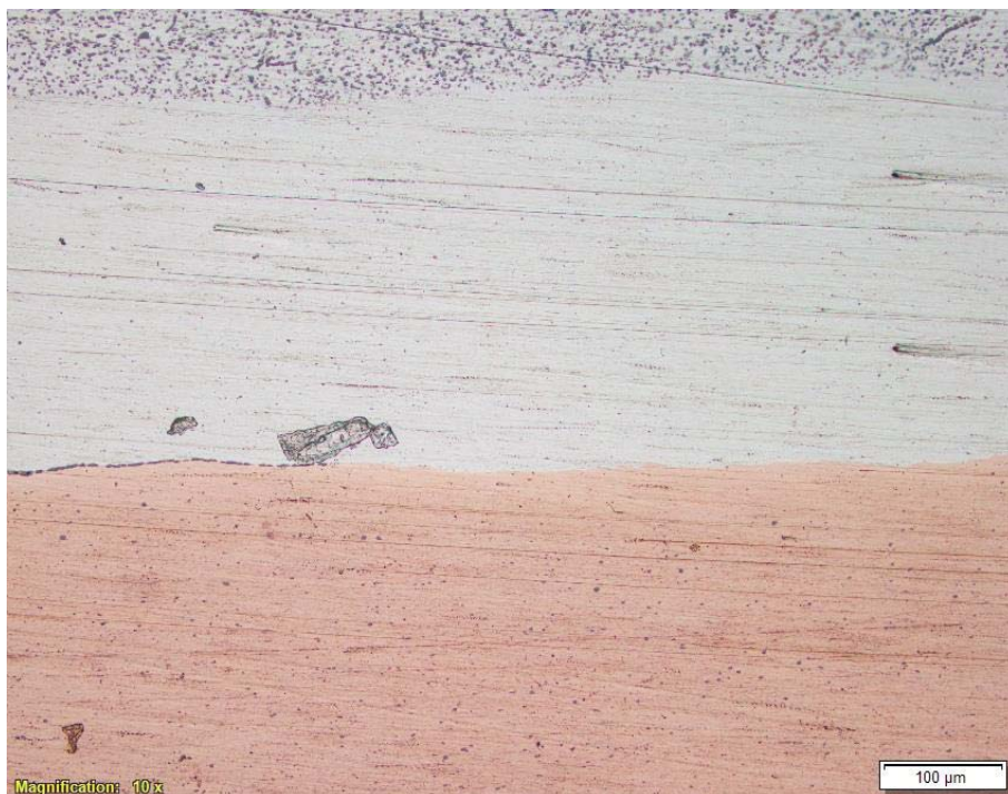
รูปที่ ก-5 ทองแดง/เงินสเตอร์ลิง อุนหนุมิ 750°C บรรยากาศแบบออกซิเดชั่น ยืนอุนหนุมิ 10 ชั่วโมง
