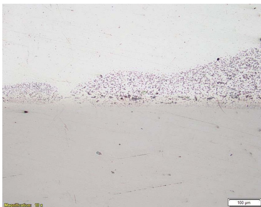
รูปที่ ก-8 แพลเลเดียม500/เงินสเตอร์ลิง อุณหภูมิ 750°C บรรยากาศแบบออกซิเดชัน ยืนอุณหภูมิ 10 ชั่วโมง
