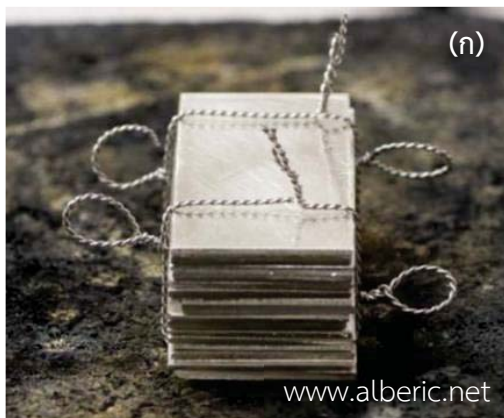
รูปที่ 3 วิธีการอัดแผ่นโลหะ (ก) การใช้ลวดมัดแผ่นโลหะให้ติดกัน (ข) การใช้แคมป์โลหะยึดแผ่นโลหะให้ติดกัน
