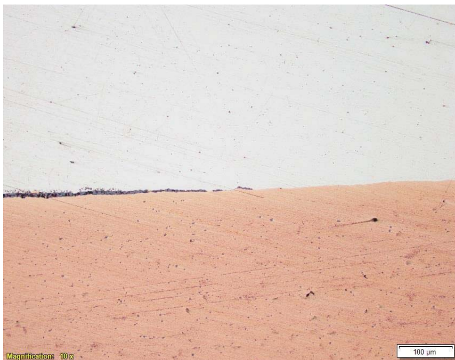
รูปที่ ก-6 ทองแดง/เงินสเตอร์ลิง อุนหนุมิ 750°C บรรยากาศแบบออกซิเดชั่น ยืนอุนหนุมิ 15 ชั่วโมง
