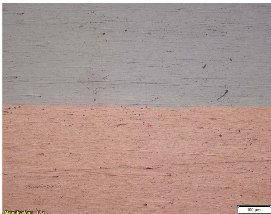
รูปที่ ก-2 ทองแดง/แพลเลเดียม500 อุณหภูมิ 750°C บรรยากาศแบบออกซิเดชัน ยืนอุณหภูมิ 10 ชั่วโมง
