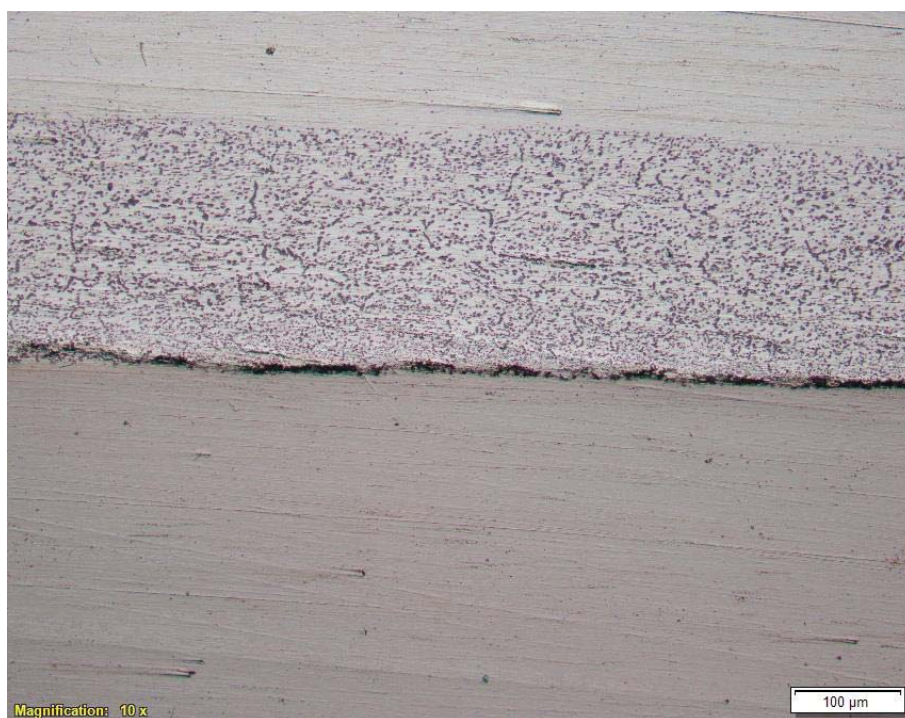
รูปที่ ก-9 แพลเลเดียม500/เงินสเตอร์ลิง อุณหภูมิ 750°C บรรยากาศแบบออกซิเดชัน ยืนอุณหภูมิ 15 ชั่วโมง
