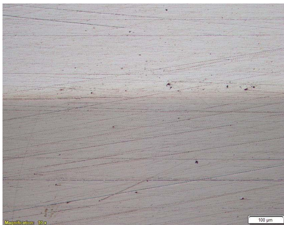
รูปที่ ก-18 แพลเลเดียม500/เงินสเตอร์ลิง อุณหภูมิ 750°C บรรยากาศแบบบริดจ์ชั้น ยืนอุณหภูมิ 15 ชั่วโมง
