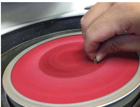
รูปที่ 24 การขัดผิวหน้าชิ้นงานสำหรับถ่ายรูปบริเวณรอยต่อด้วยกล้องจุลทรรศน์แสง
