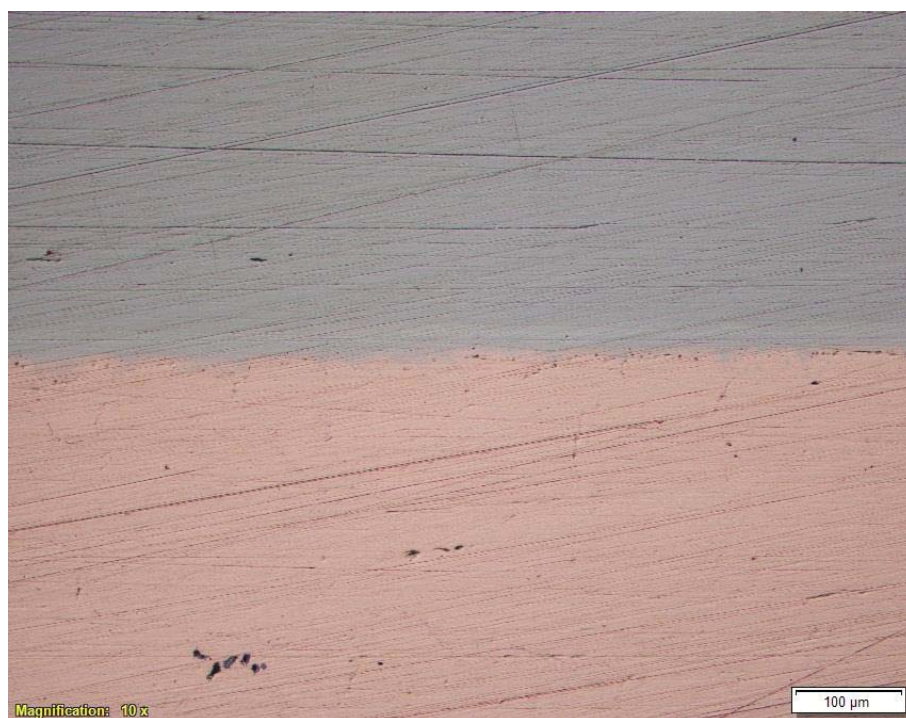
รูปที่ ก-12 ทองแดง/แพลเลเดียม500 อุณหภูมิ 750°C บรรยากาศแบบบริดจ์ชั้น ยืนอุณหภูมิ 15 ชั่วโมง
