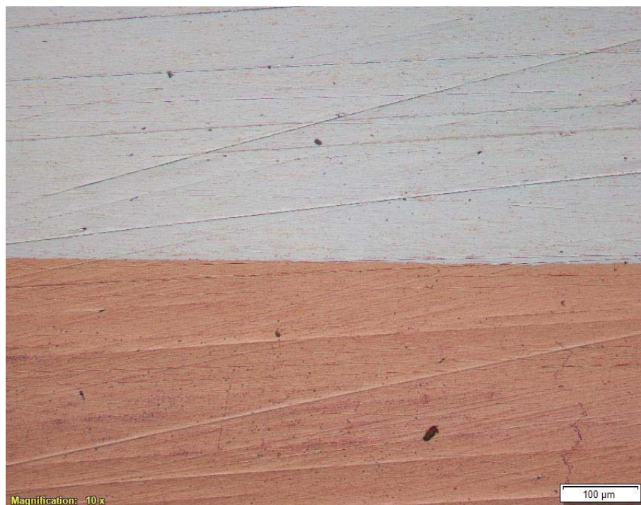
รูปที่ ก-14 ทองแดง/เงินสเตอร์ลิง อุณหภูมิ 750°C บรรยากาศแบบปิดกั้น ยืนอุณหภูมิ 10 ชั่วโมง
