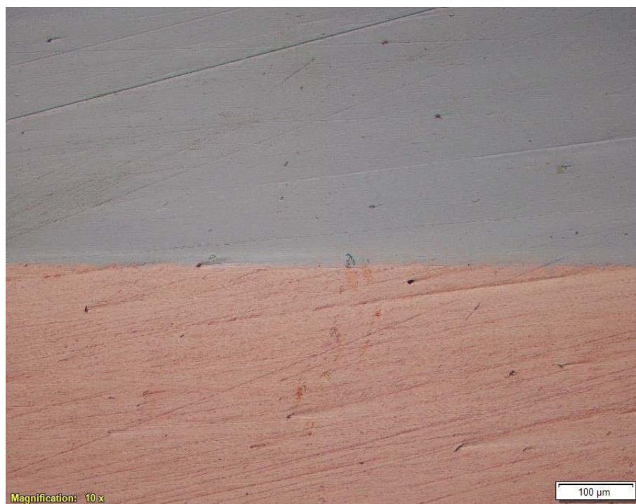
รูปที่ ก-11 ทองแดง/แพลเลเดียม500 อุณหภูมิ 750°C บรรยากาศแบบบริดจ์ชั้น ยืนอุณหภูมิ 10 ชั่วโมง
