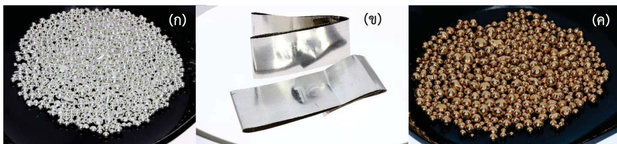
รูปที่ 12 โลหะที่ใช้ในการเตรียมแพลเลเดียม 500 และเงินสเตอร์ลิง (ก) โลหะเงิน 99.99% (ข) โลหะแพลเลเดียม 99.99% (ค) โลหะทองแดง 99.99%
