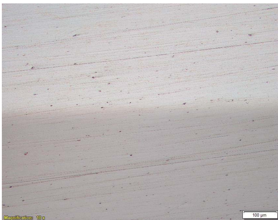
รูปที่ ก-16 แพลเลเดียม500/เงินสเตอร์ลิง อุณหภูมิ 750°C บรรยากาศแบบบริดจ์ขึ้น ยืนอุณหภูมิ 5 ชั่วโมง
