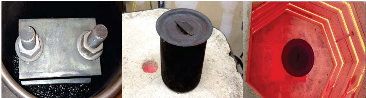
รูปที่ 7 การอบชิ้นงานด้วยเตาไฟฟ้า (Binnion J., 2016)
