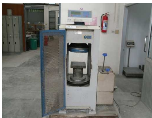
รูปที่ 3.33 เครื่องทดสอบกำลังอัดคอนกรีต
