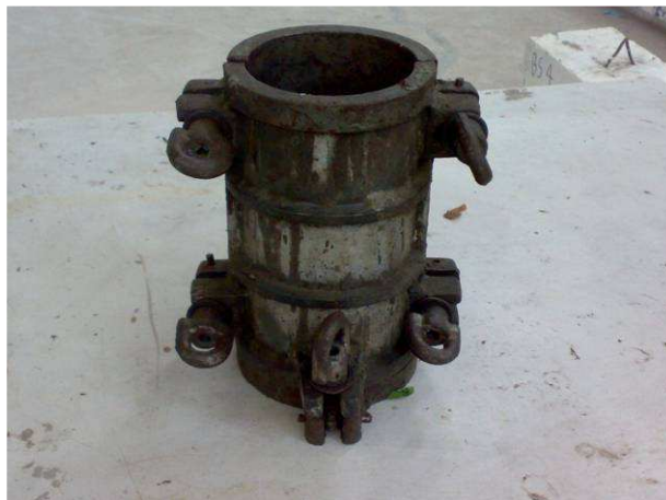
รูปที่ 3.12 แบบหล่อขึ้นตัวอย่างคอนกรีตสูง 20 เซนติเมตร และเส้นผ่านศูนย์กลาง 10 เซนติเมตร
