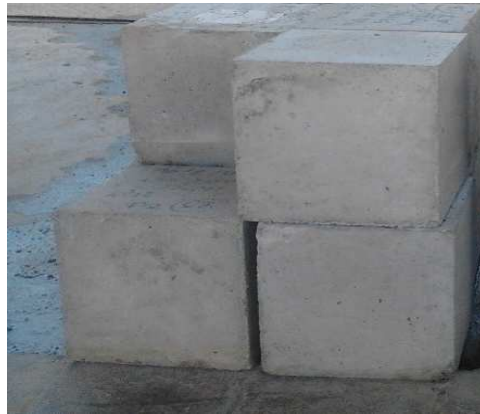
รูปที่ 3.32 ตัวอย่างคอนกรีตทรงลูกบาศก์ขนาด 10 \times 10 \times 10 ซม. 3
