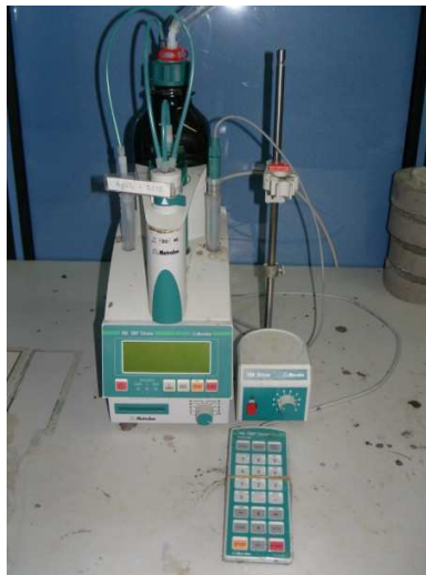
รูปที่ 3.5 เครื่อง Auto titration รุ่น 785 DMP Titrino Metrohm และ เครื่องกวนแม่เหล็ก
