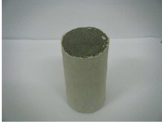
รูปที่ 3.20 ตัวอย่างที่บ่มในน้ำประปาครบ 28 วัน แล้วทำการเคลื่อนผิวตัวอย่าง
