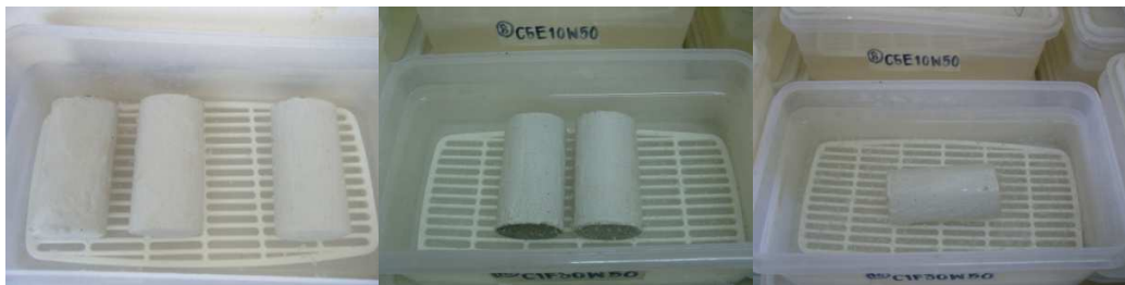
รูปที่ 3.21 ตัวอย่างที่แช่ในน้ำเกลือเป็นระยะเวลา 35 91 และ 182วัน ตามลำดับ
